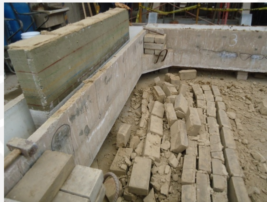
Foto 6.29. Fin del Ensayo de Inundación para el Muro con Sobrecimiento MC, volteo a mano del muro de adobe.
