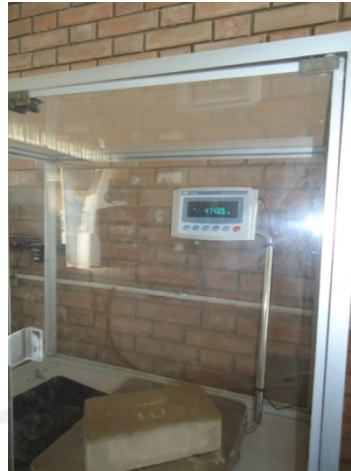
Foto 4.5. Pesado del espécimen al concluir la Prueba de Succión.
