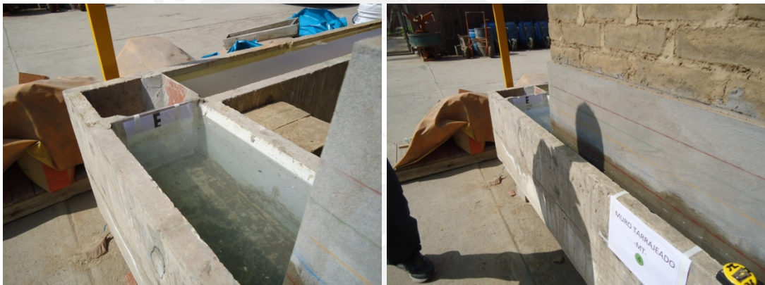
Foto 6.16. Ensayo de Inundación en Muro Tarrajado MT, se aprecia la claridad y transparencia del agua.
