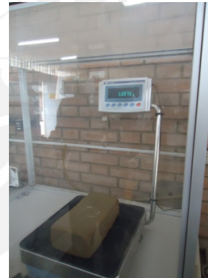
Foto 4.9. Registro del peso del adobe al finalizar la prueba.
