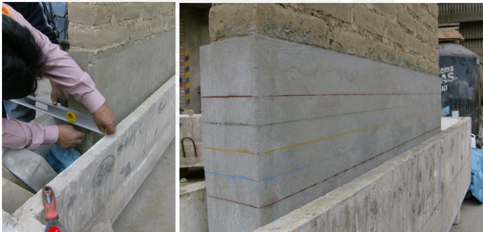
Foto 4.2. Niveles para medir el ascenso de agua por capilaridad en muros durante el ensayo de inundación.
