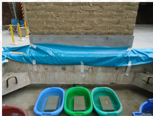
Foto 5.15. Primer minuto de la prueba de absorción en adobes tarrajados.
