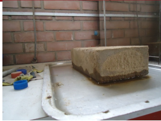
Foto 5.1 Ascenso capilar de agua de 2.00 cm en espécimen Patrón
