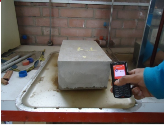
Foto 5.7. Espécimen de adobe tarrajado tras un minuto de exposición al agua. Nótase el ascenso capilar de agua del orden de 0.50 cm.
