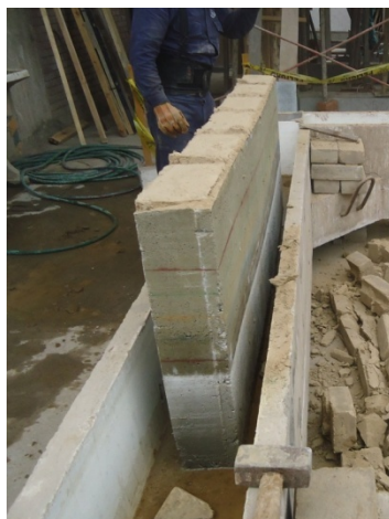
Foto 6.29. Fin del Ensayo de Inundación para el Muro con Sobrecimiento MC, volteo a mano del muro de adobe.
