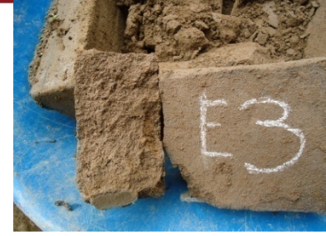
Foto 6.13. Hilada 03 ME. Núcleo parcialmente saturado.
