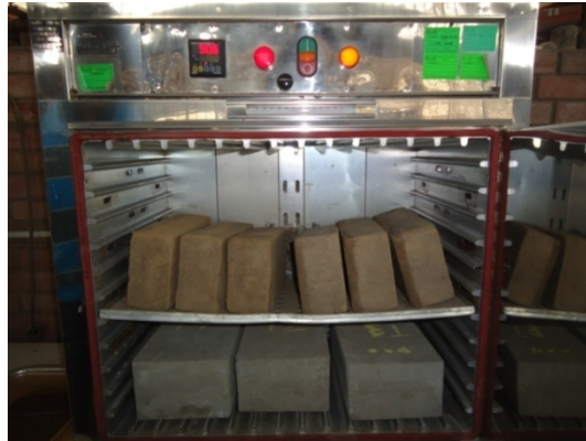
Foto 4.1. Horno marca Memmect para el secado de los especímenes durante 24 horas. Temperatura de secado: 110°C.
