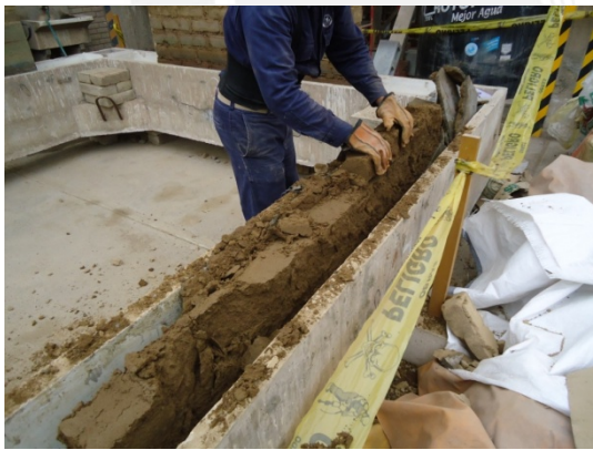
Foto 6.23. Base del Muro Tarrajeado MT terminado el ensayo de inundación. La malla fue removida.
