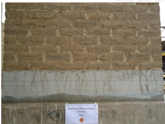
Foto 6.27: Día 3 del Ensayo de Inundación en Muro con Sobrecimiento MC, se aprecia un ascenso por capilaridad de unos 9 cm en el concreto.
