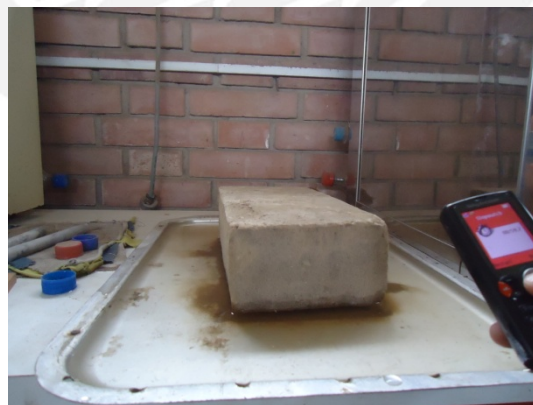
Foto 4.4. Especimen sometido a la prueba de succión.
