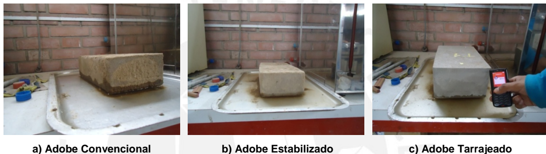
Foto 5.23. Detalle de ascenso capilar en los diferentes especímenes.
