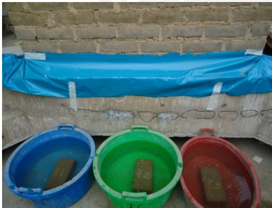
Foto 5.12 Primer minuto de inmersión en agua de adobes estabilizados.
