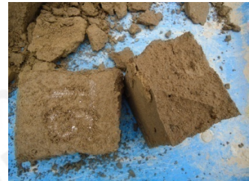
Foto 6.22. Hilada 05 MT. Núcleo con saturación total.
