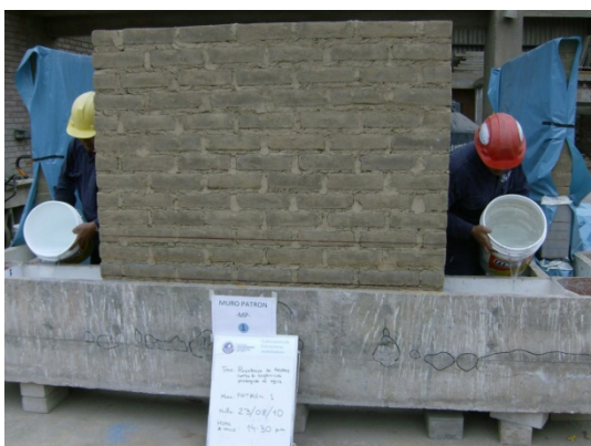
Foto 6.2. Inicio del Ensayo de Inundación en Muro Patrón, 2:30 pm del 23/08/2010.
