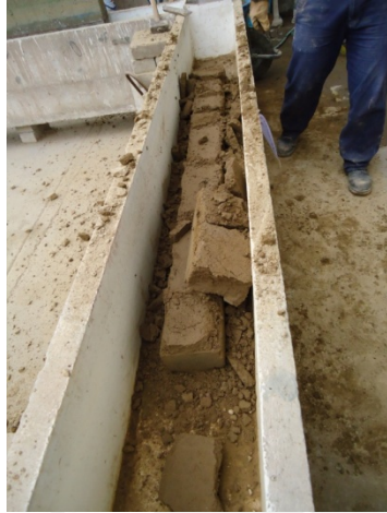
Foto 6.11. Hilada 11 ME. Núcleo estable sin presencia de humedad.
