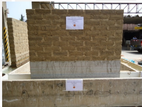
Foto 3.9. Muro con Sobrecimiento MC.
