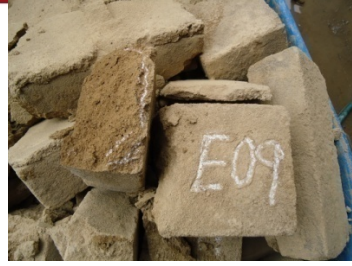
Foto 6.12. Hilada 09 ME núcleo con evidencia inicial de humedad.
