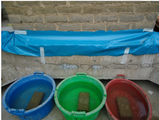
Foto 4.8. Especímenes sometido a la prueba de absorción.
