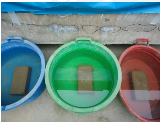
Foto 5.14. Estado final de los especímenes de adobe estabilizado tras concluida la prueba de absorción.
