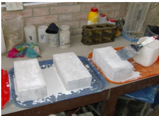
Foto 5.20. Aplicación de 2 capas de Plasticoat sobre adobes convencionales. Tiempo de secado entre capas: 24 horas.
