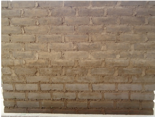
Foto 6.9. Día 16 del ensayo de inundación en Muro Estabilizado ME; se aprecia ascenso por capilaridad por encima del nivel de 6 hiladas, 3 de las cuales son de adobes convencionales.
