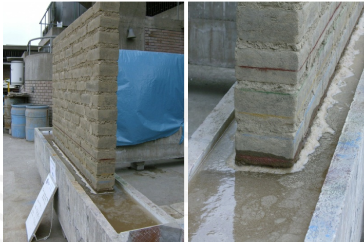
Foto 6.3. Primeros 5 minutos del Ensayo de Inundación del Muro Patrón MP, se aprecia una densa turbidez y espuma en el agua.
