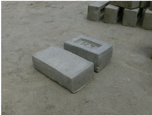
Foto 2.2. Comparación entre las dimensiones de los adobes mandados a fabricar y los encontrados de otro lote regular marcados con las siglas LM.
