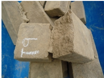
Foto 6.20. Hilada 09 MT. Núcleo estable sin presencia de humedad.
