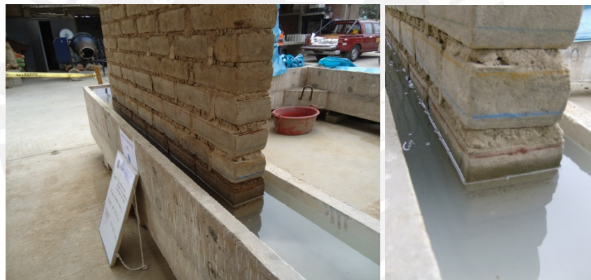
Foto 6.7. Primeros 5 minutos del Ensayo de Inundación del Muro Estabilizado ME.
