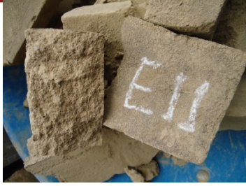
Foto 6.11. Hilada 11 ME. Núcleo estable sin presencia de humedad.
