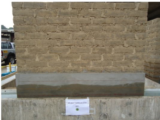
Foto 6.17. Día 3 del Ensayo de Inundación en Muro Tarrajado, se aprecia que por encima del nivel de agua, la capilaridad ha ascendido hasta 18 cm.
