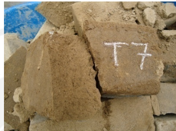
Foto 6.21. Hilada 07 MT. Núcleo parcialmente saturado.
