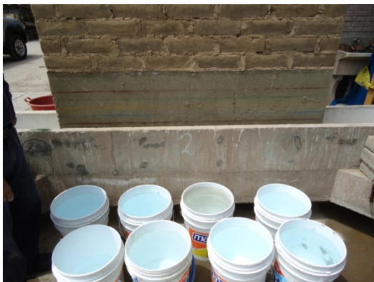
Foto 6.24. Preparación del Ensayo de Inundación en Muro con Sobrecimiento MC.
