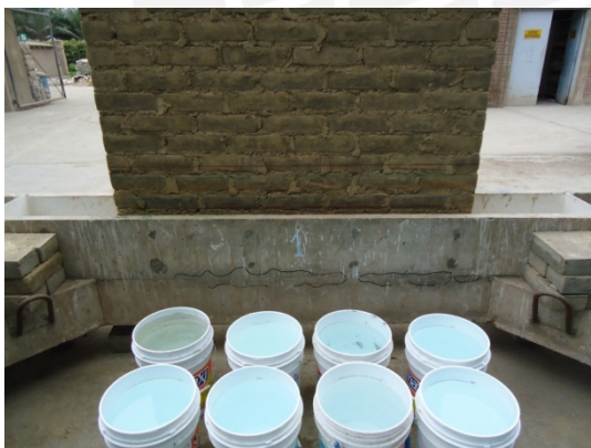
Foto 6.1. Preparación del Ensayo de Inundación en Muro Patrón, nótase que se usaron baldes para verter un volumen conocido.
