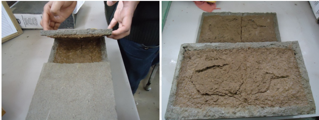
Foto 5.18 Estado interno del espécimen T1. Nótese el estado de saturación del adobe convencional contenido en el armazón de tarrajeo.
