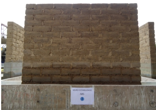
Foto 6.8. Día 3 del ensayo de inundación del Muro Estabilizado ME; se aprecia un ascenso por capilaridad de 2 1/2 hiladas.
