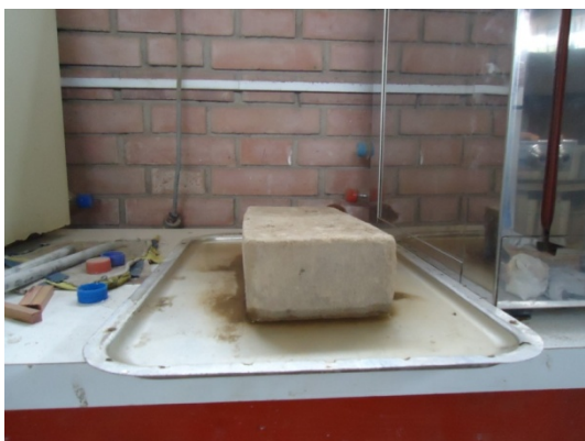
Foto 5.4 Prueba de succión en espécimen de adobe estabilizado. Nótese el ascenso capilar de agua del orden de 1.00 cm.
