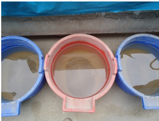
Foto 5.11. Estado final de los especímenes de adobe convencional tras concluida la prueba de absorción.
