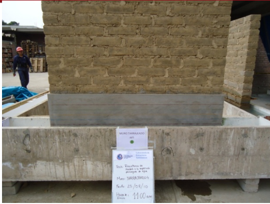
Foto 6.15. Inicio del Ensayo de Inundación en Muro Tarrajado MT, 11:30 am del 25/08/2010.
