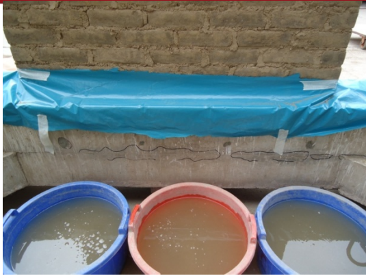
Foto 5.10. Cinco primeros minutos de la prueba de absorción, se observa una desintegración casi total de las tres muestras de adobe convencional.
