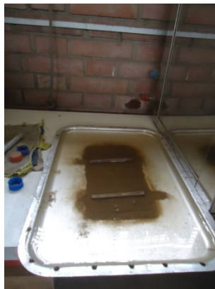
Foto 5.1 Ascenso capilar de agua de 2.00 cm en espécimen Patrón
