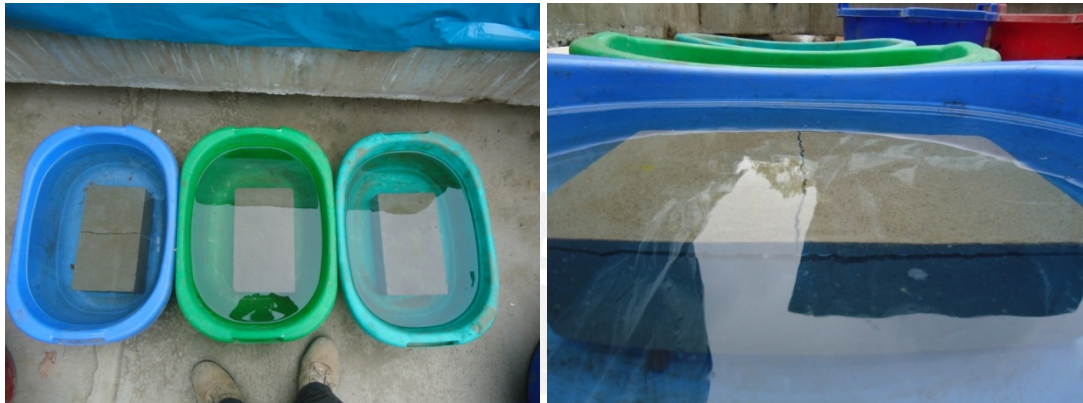
Foto 5.16. Adobes tarrajeados al concluida la prueba de absorción. Nótese la fisuración en el contorno y parte media de la cara superior del espécimen T1.
