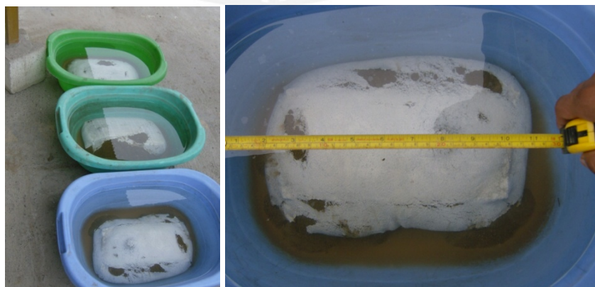
Foto 5.22. Adobes impermeabilizados al finalizar la prueba de absorción. Nótese la desintegración de los tres especímenes y la rotura de la película impermeabilizante en cada caso.
