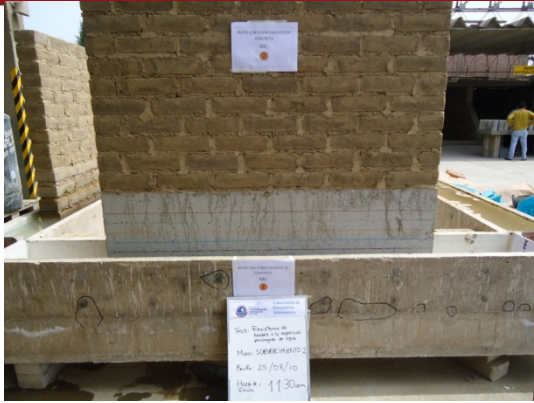
Foto 6.25. Inicio del Ensayo de Inundación en Muro con Sobrecimiento MC, 11:30 p.m. del 25/08/2010.
