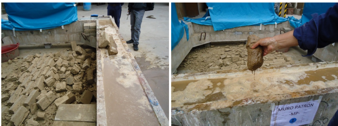
Foto 6.4. Volcadura del muro patrón ante el ensayo de inundación. Nótese el estado de los adobes luego de 20 minutos de someterse a inundación.
