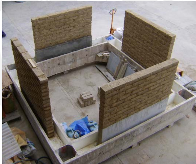
Foto 3.7. Vista superior de los cuatro muros de adobe construidos sobre el canal de concreto armado para la prueba de inundación.
