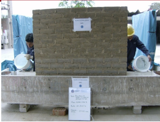
Foto 6.6. Inicio del ensayo de inundación en Muro Estabilizado ME, 09:00 am del 24/08/2010.
