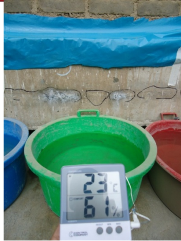
Foto 4.7. Registro de la temperatura del agua usada en la prueba de absorción.
