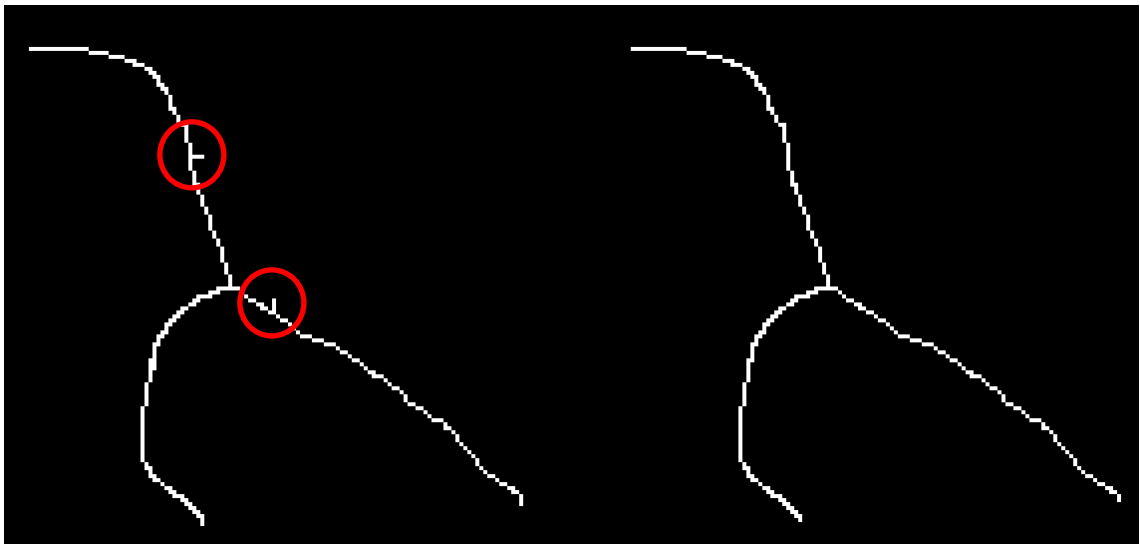
Figura 4.2. Limpieza previa a la caracterización del esqueleto del río.
