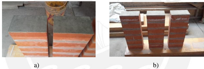
Figura 3.4. (a) Refrentado sobre superficie de pilas, (b) pilas terminadas
