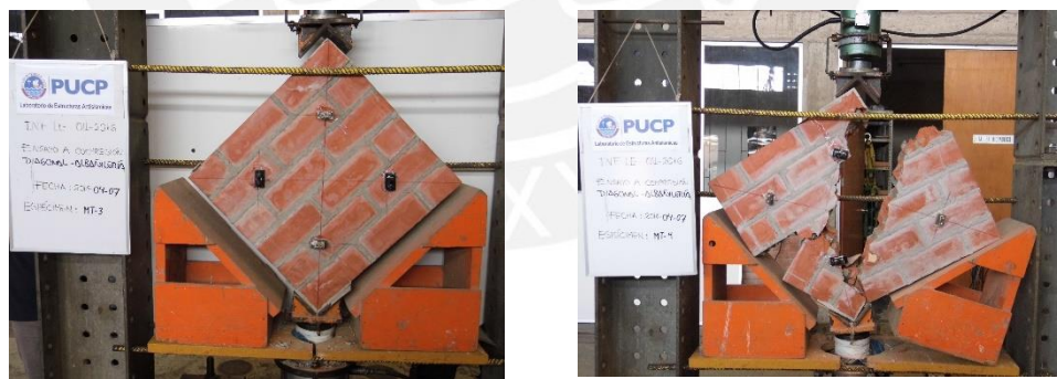
Figura 3.18. Estado previo y posterior al ensayo del murete MT 3
