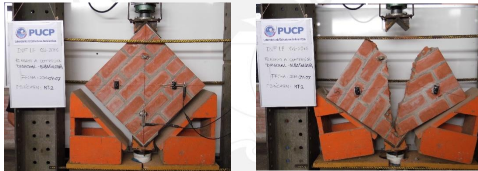
Figura 3.20. Estado previo y posterior al ensayo del murete MT 2
