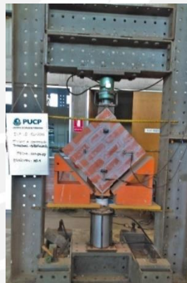
Figura 3.16 Instrumentación del murete MT4
