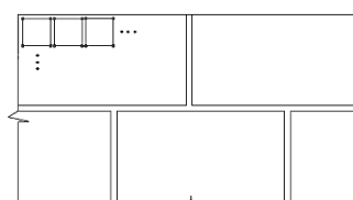
Figura 2.26. Representación de los elementos finitos del modelo y sus nodos
