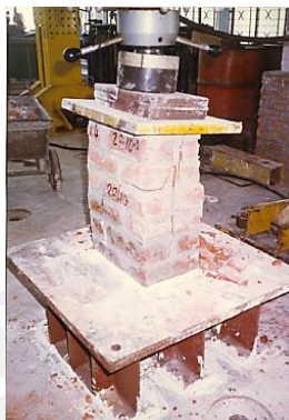
Figura 2.16. Patrón de falla de un prisma con esbeltez igual a 3 (Ganapathi et al., 2011)
