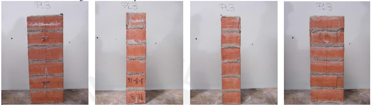
Figura 3.8. Falla en pila PL-03 vista desde las cuatro caras de la misma
