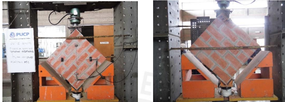
Figura 3.19. Estado previo y posterior al ensayo del murete MT 1
