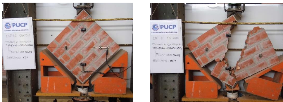
Figura 3.17. Estado previo y posterior al ensayo del murete MT 4
