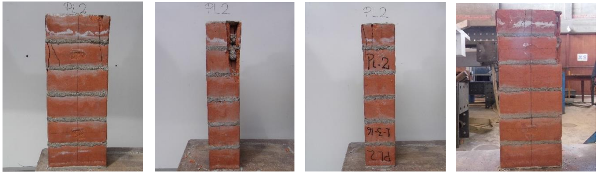
Figura 3.9. Falla en pila PL-02 vista desde las cuatro caras de la misma
