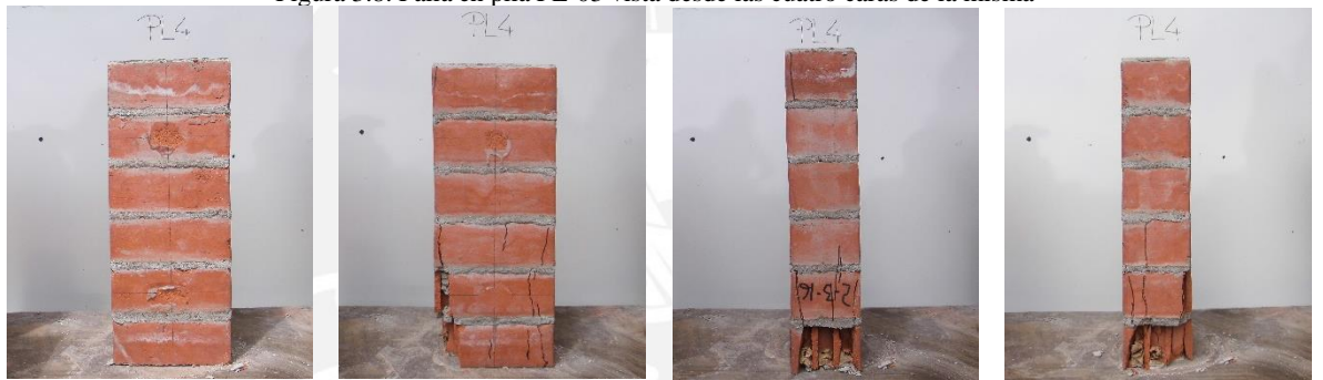
Figura 3.10. Falla en pila PL-04 vista desde las cuatro caras de la misma
