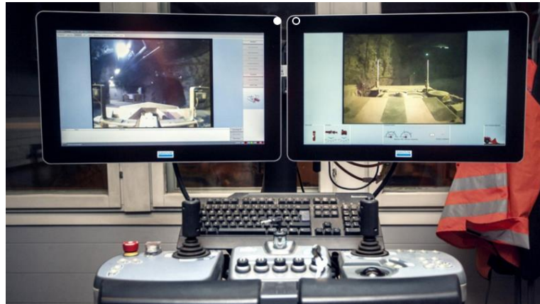
Figura 1.10: Estación Sandvik de teleoperación de la perforación [17].
