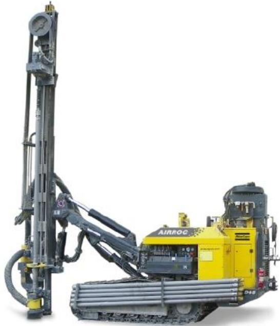
**Figura A.13:** AirROC D45 con martillo neumático en fondo [53].
