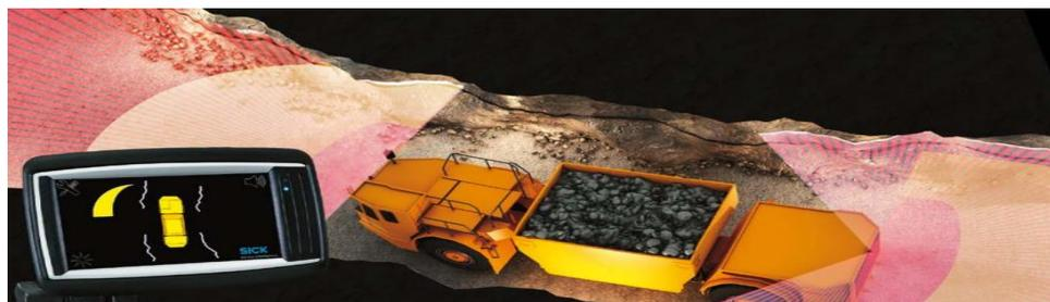
**Figura A.25:** Descripción de las zonas del sistema de detección de proximidad [68].
