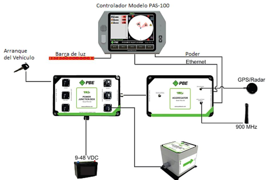
**Figura A.24:** Sistema de detección de proximidad desarrollado por PBE [67].
