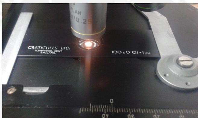
Figura 3.7: Medición del diámetro del campo de visión en el microscopio LEICA, DM LM.
