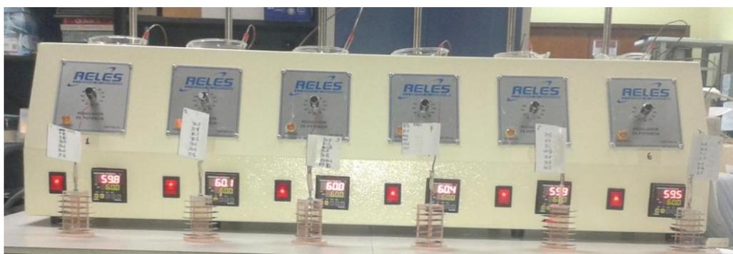
Figura 3.5: Estabilización de la temperatura en el sistema termostático:  $60 \pm 0,5$  °C.
