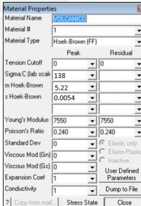
Figura 36 – Parámetros de entrada para la evaluación de la secuencia de minado de UnderMiningSAC.
