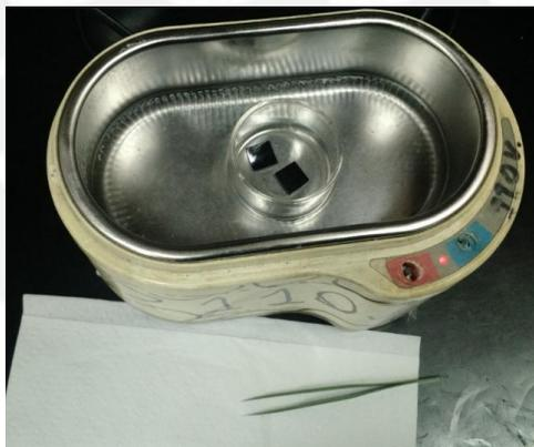
Figura 3.17: Limpieza de las muestras de silicio puestos en baño maria, dentro de la sonificadora.
