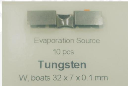
Figura 3.19: Crisol de Tungsteno, de 1mm de espesor de dimensiones adecuadas para encajar en los electrodos de la evaporadora Balzers.
