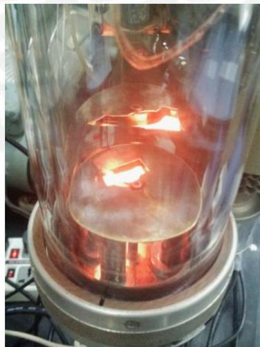
Figura 3.22: Momento preciso donde se abre el Shutter y comienza la deposición con un rate lento, claramente se ve como se oscurece el tubo de vidrio.
