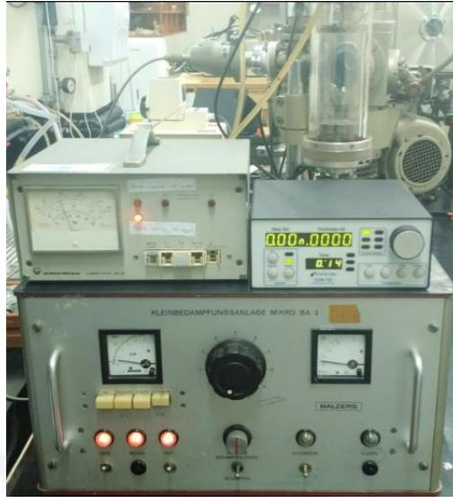
Figura 3.21: La evaporadora Balzers, habilitada para la evaporación.
