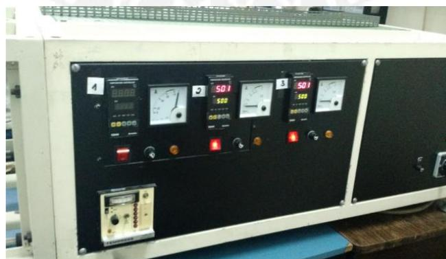
Figura 3.27: Muestra al horno seteado a  $500^\circ\text{C}$ . Se monitorea la temperatura hasta que se estabilice (aprox. 40 min.) antes de hacer el annealing.
