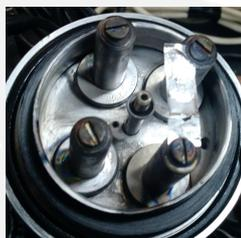
Figura 3.9: Crisol de tungsteno después de evaporar aluminio, se ve como el aluminio hace una aleación con el tungsteno.
