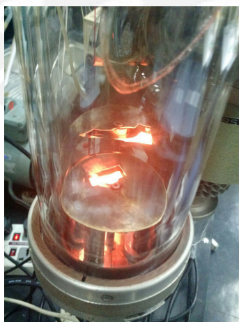
Figura 3.22: Deposición de los contactos de aluminio.
