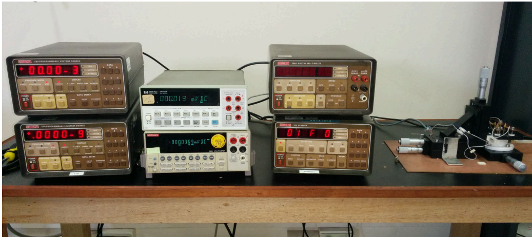
Figura 3.10: Sistema 1 para mediciones de corriente-voltaje y de resistividad por el método de Van der Pauw.
