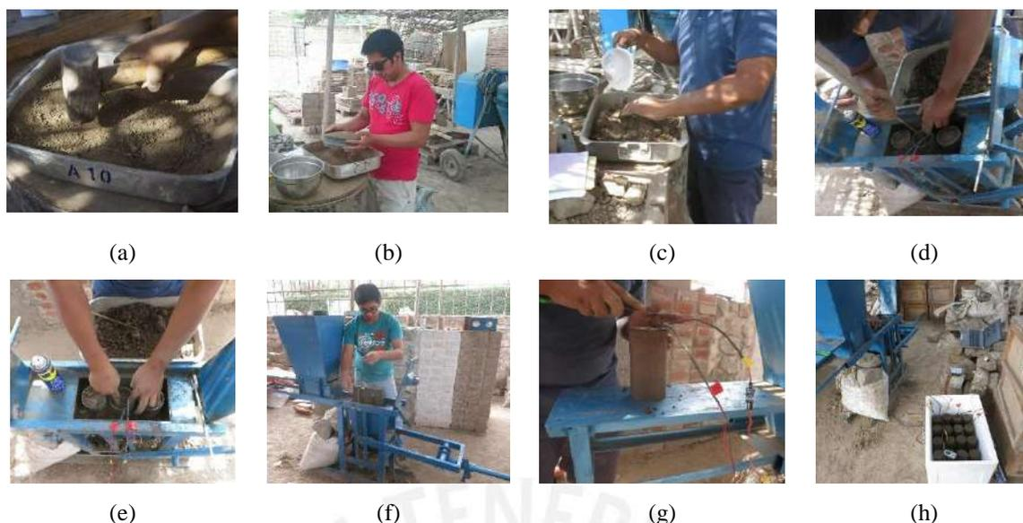
**Figura 3.7** Etapas para la fabricación de especímenes de tierra (a) Trituración (b) Tamizado (c) Mezclado con agua (d) Compactación (e) Colocación de sensores (f) Expulsión de probetas (g) Enrazado (h) Monitoreo continuo.
