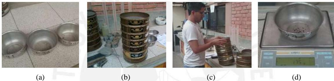
**Figura 3.3** Ensayos de granulometría, método del tamizado (a) Muestras que pasan las diferentes mallas. (b) Colección de tamices. (c) Sarandeo de las partículas. (d) Peso de las partículas retenidas en los tamices.
