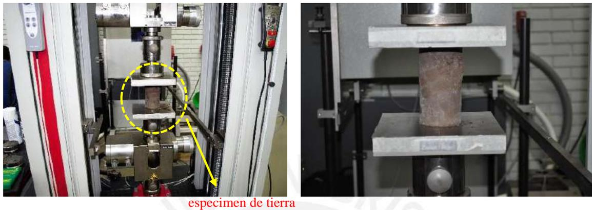
**Figura 3.9** Maquina universal de carga modelo Swick/Roell Z050 para realizar los ensayos a compresión de especímenes de tierra.
