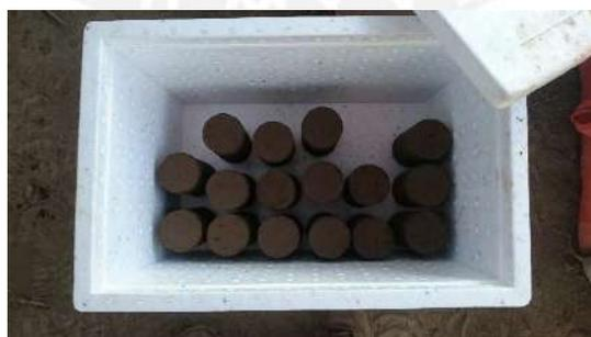
**Figura 3.8** Especímenes de tierra el día de la fabricación.
