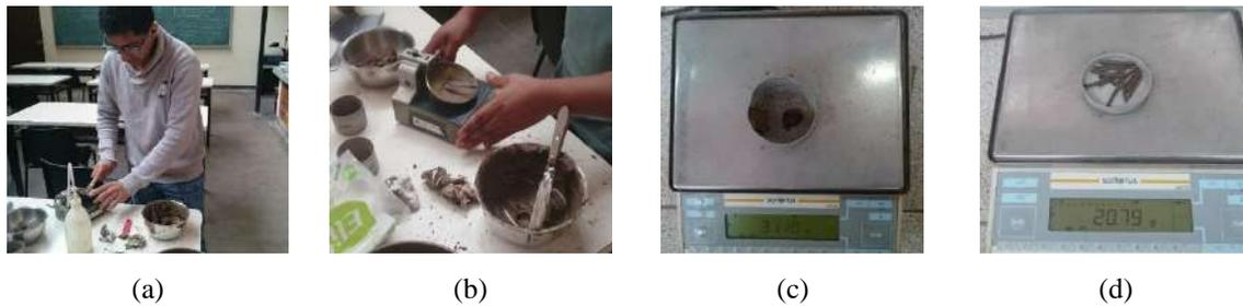
**Figura 3.1** Ensayos de límites de Atterberg (a) Preparación de muestras. (b) Golpes con la cuchara de Casagrande. (c) Peso de muestra para el límite líquido. (d) Peso de la muestra para el límite plástico.
