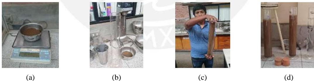
**Figura 3.4** Ensayos de granulometría, método del hidrómetro (a) Peso de la muestra. (b) Materiales para el batido de la mezcla. (c) Agitación de la muestra. (d) Proceso de sedimentación en diferentes horas.
