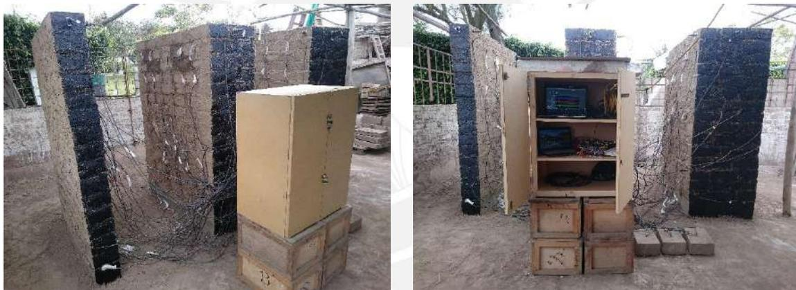
**Figura 5.15** Lugar de emplazamiento y centro de monitoreo continuo de tres muros de adobe.
