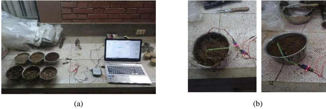
**Figura 3.16** Mediciones de humedad (a) Sistema de adquisición de datos (b) Obtención de voltajes.
