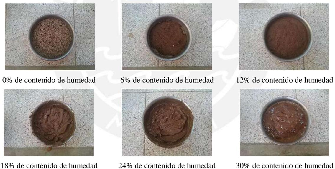
**Figura 3.15** Muestras con diferente contenido de humedad (a) 0%, (b) 6%, (c) 18% (d) 24% (e) 30%.
