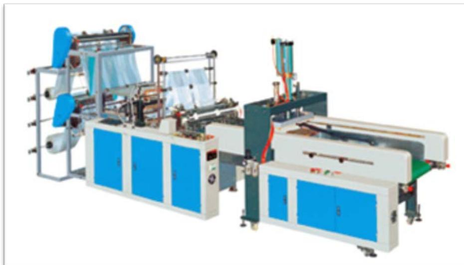
Figura 3.6: Cortadora automática y selladora controlada por computadora
