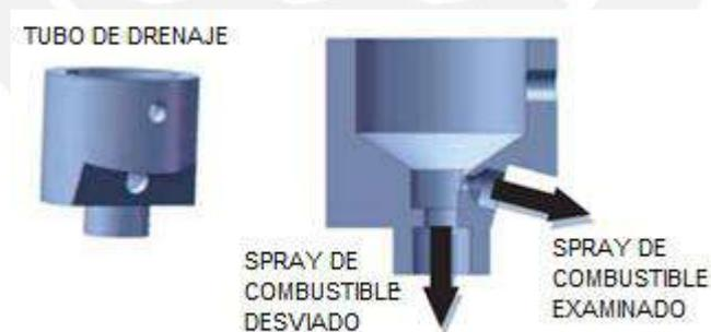
Figura 1.19: Inyector del banco de prueba [14].
