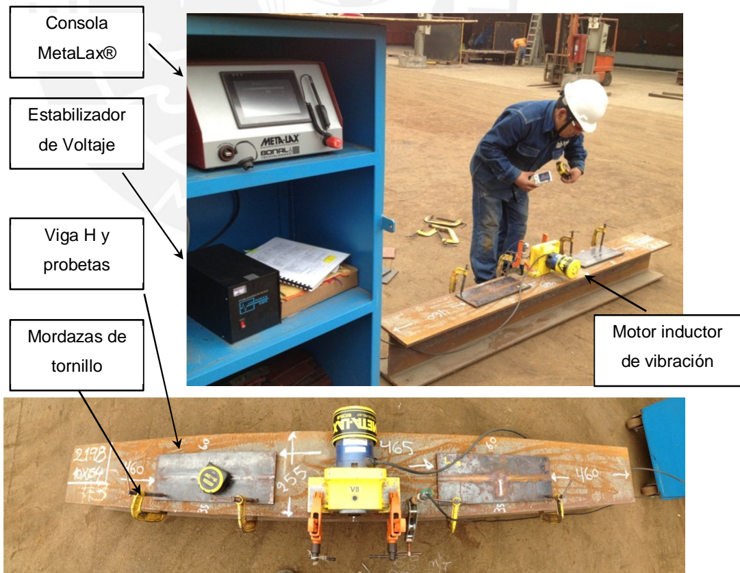
Figura 34. Arreglo para alivio de tensiones en taller el 16 de mayo del 2014.
