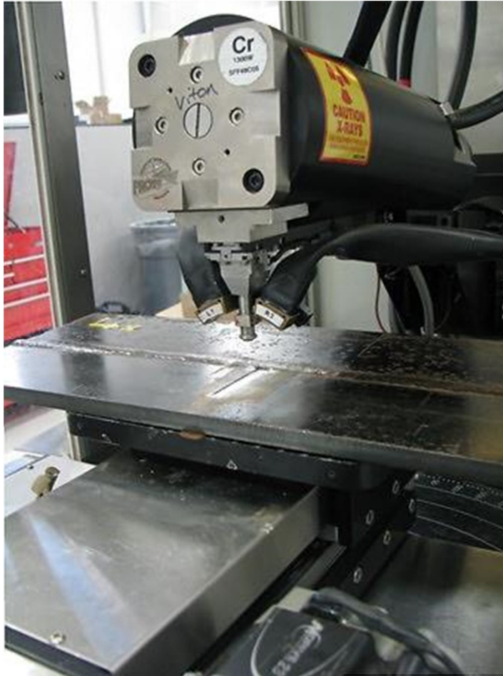
Figura 27. Difractómetro de laboratorio LXRD 11999 con probeta 9AV2
