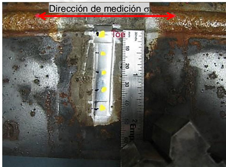
Figura 30. Detalle de zona electropulida en probetas (0.5 mm profundidad).
