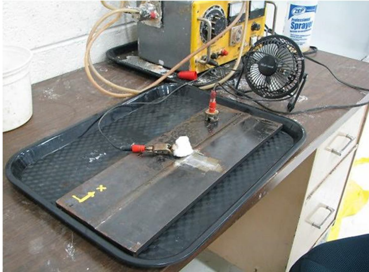
Figura 29. Proceso de electropulido en Laboratorio.
