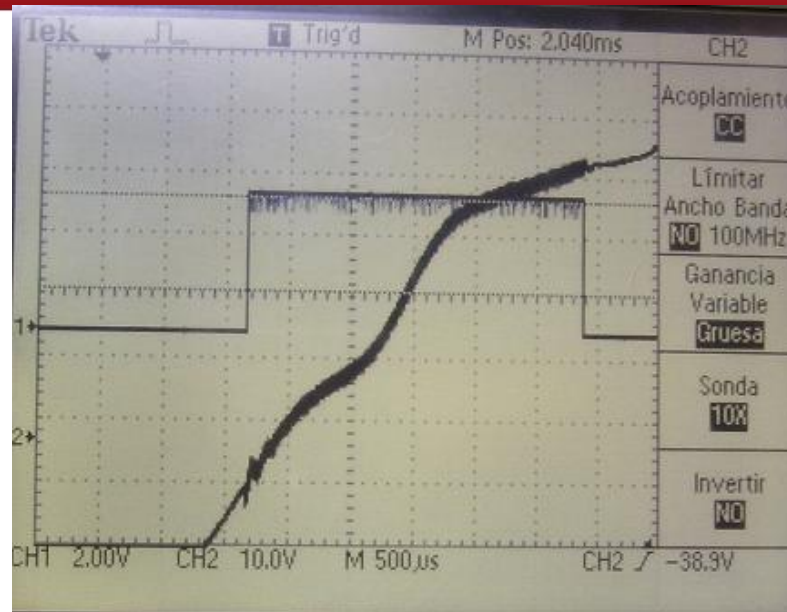
Fig. 32: Señal PWM acoplada a la red eléctrica y pulso de 2.5 mseg. como referencia de ventana de tiempo
