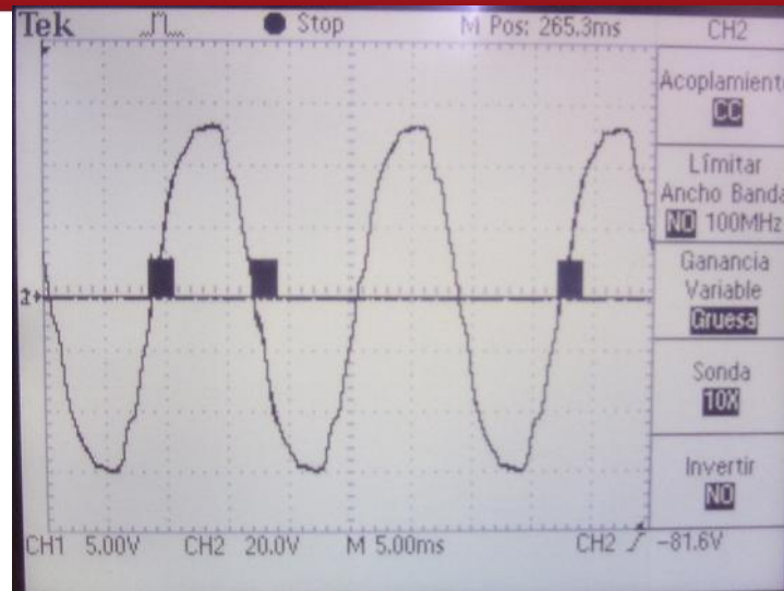
Fig. 30: Canal 1 Señal de referencia 50VAC 60Hz y Canal 2 Señal PWM
