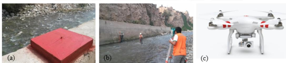
Figura 3.4: (a) Hito de concreto ubicado en el margen derecho del cauce. (b) Medición de una las secciones del tramo estudio. (c) UAV empleado para el registro de fotografías aéreas.
