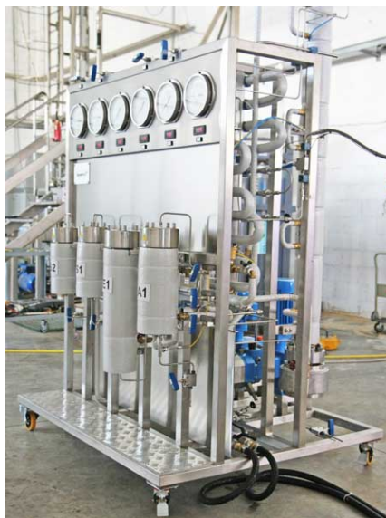
Figura 2.15: Supercritical Pilot Plant, planta piloto ofrecida por SEPARECO.
