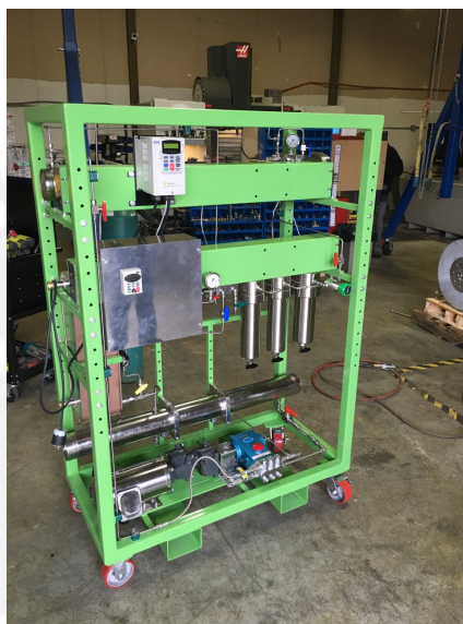
Figura 2.11: Modular Fluid Extractor (MFE), planta piloto ofrecida por Infinity Supercritical.
