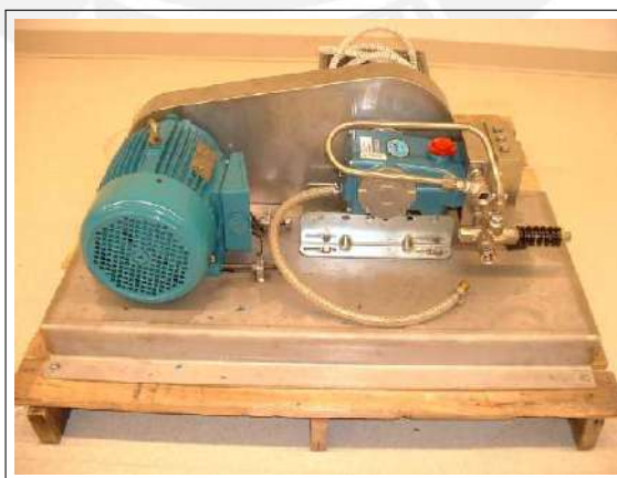
Figura 2.6: Bomba de desplazamiento positivo para CO 2 (Rosenthal, 2012).
