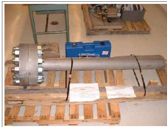
Figura 2.8: Columna de separación (Rosenthal, 2012).
