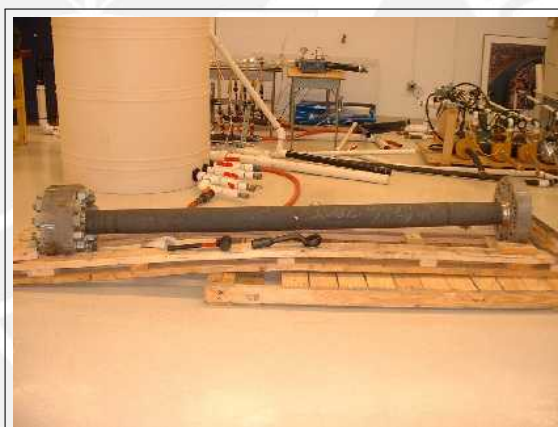
Figura 2.7: Columna de Extracción (Rosenthal, 2012).
