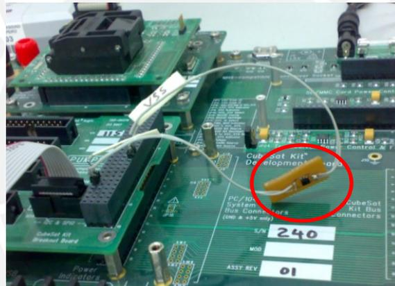
**Figura No 23.** Tarjeta electrónica fabricada con el sensor SHT21 (en rojo), que se conecta al módulo de desarrollo para el Microcontrolador MSP430.
