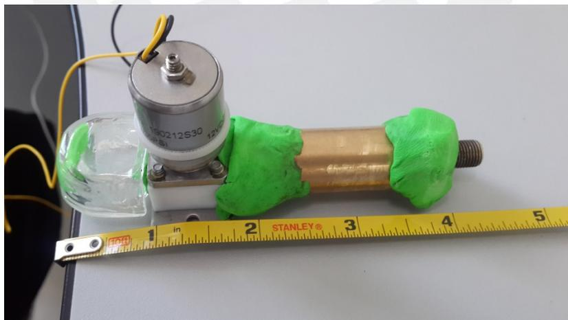
**Figura No. 30.** Largo del prototipo medido en pulgadas. Cámara de crecimiento CC: 1" (2.5cm), base de microválvula: 0.8" (2cm), cámara de almacenamiento CA: 2" (5cm)
