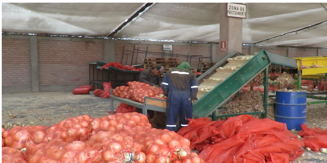
Figura 53. Seleccionadora de calibre de cebolla amarilla dulce Tomado de “Archivo personal,” por Chepote, 2016 (foto tomada en la entrevista personal con el ingeniero Chepote, octubre 2016)
