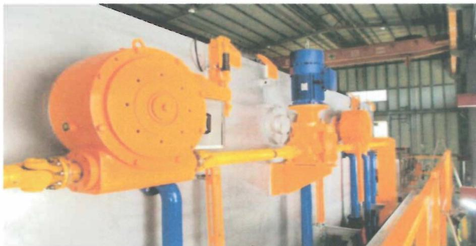
*Figura 1.2. Sistema de transmisión de lavadora de botellas (12)*
