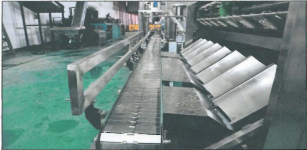
*Figura 1.4. Mesa de descarga de una máquina lavadora de botellones de 5 galones con capacidad para 1200BPH (12)*
