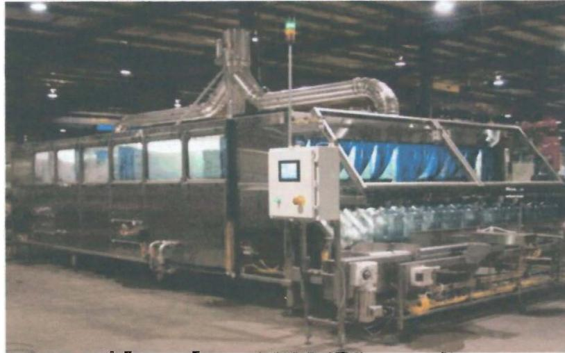
**Figura 1.6. Lavadora de botellones con capacidad para 3000 BPH (4).**
