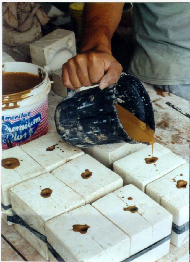
Liberando la pieza Sacamos la pieza del molde luego de poner la pieza en el horno.
