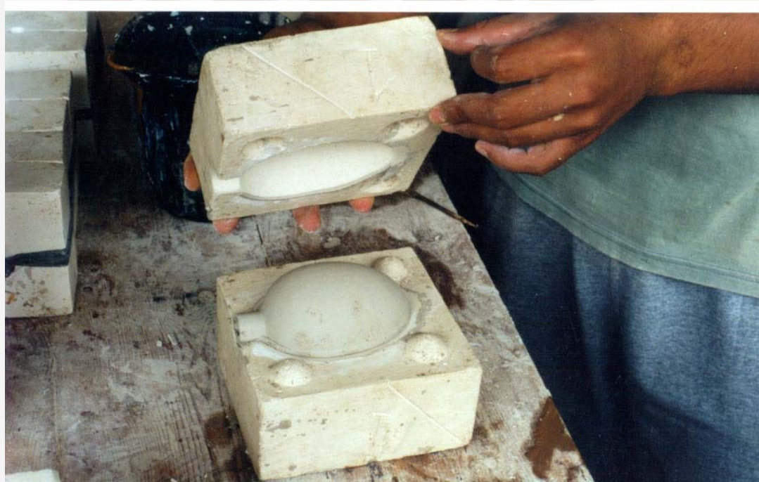
Liberando la pieza Sacamos la pieza del molde luego de poner la pieza en el horno.
