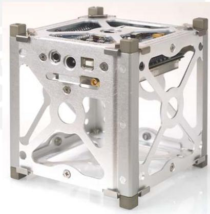
Fig. 1.1 Estructura básica de un satélite CubeSat estándar.
