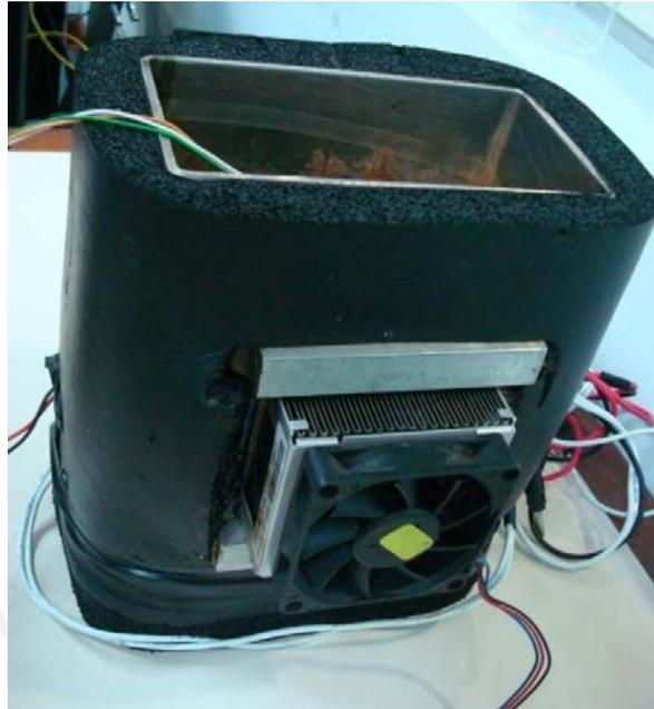
**Fig. 4.9 Tanque de aluminio con dispositivo Peltier acoplado**
