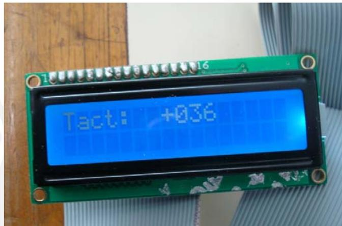
**Fig.3.14** Display LCD utilizado para visualizar al temperatura actual
