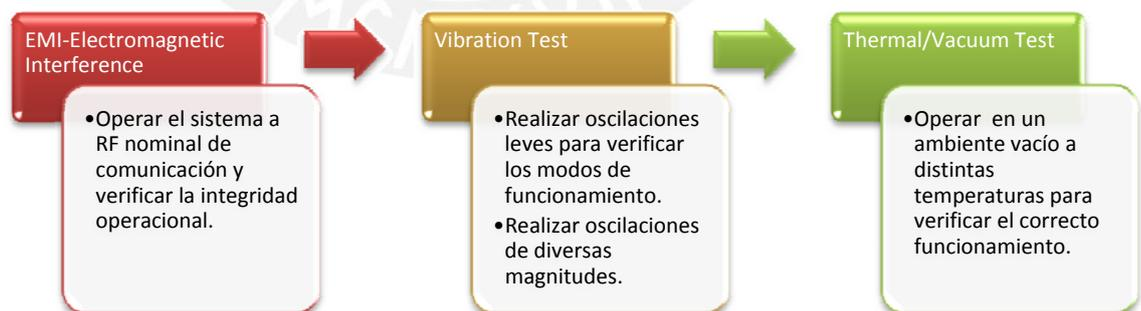
**Fig.2.1 Secuencia de pruebas ambientales.** Programa de calificación para un CubeSat de Montana State University (MSU). [9]
