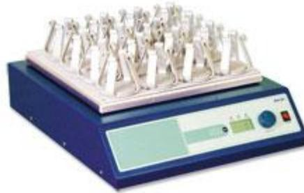
*Figura 2.8. Agitador orbital 7868B mostrado con plataforma universal 7868G*
