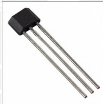
Figura 3.30. Sensor TD5A de la compañía Honeywell
