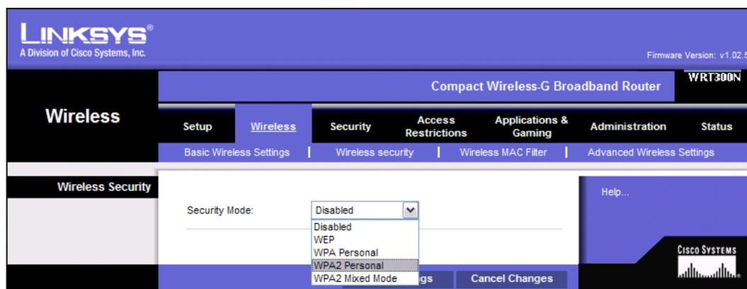
Figura 4.11 Pantallas firmware de equipo Linksys WR300 configurar Seguridad. [3]
