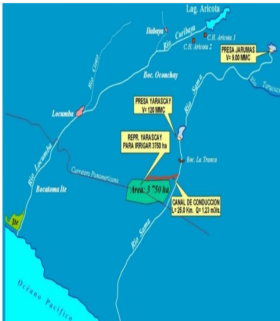
Figura 49. Proyecto de Represamiento Yarascay. Tomado del “Plan Jorge Basadre,” por el Gobierno Regional de Tacna, 2012 ( http://www.regiontacna.gob.pe/pagina/grt/documentos/2011/personal/anexoplanbasadre.pdf ).
