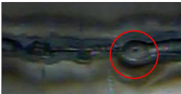
Figura 3.26. Porosidad en la unión soldada
