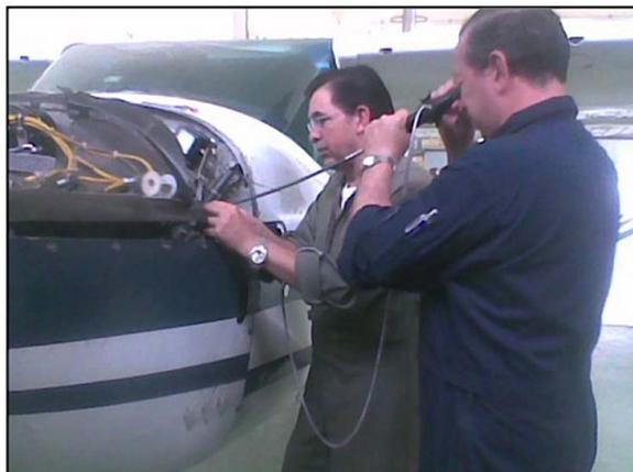
Figura 1.3. Fibroscopio [4]
