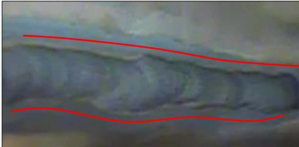
Figura 3.23. Penetración excesiva de la unión soldada
