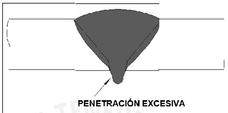
Figura 1.8. Penetración excesiva
