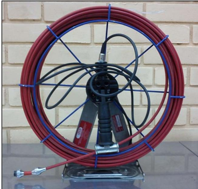
Figura 3.5 Carrete portacable de la cámara
