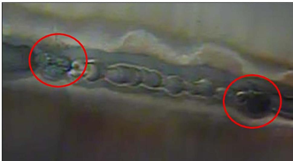
Figura 3.20. Tramos de la unión soldada oxidada
