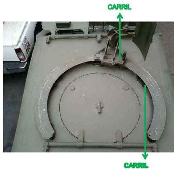
Figura A.5.2-2 Parte superior del tanque.
