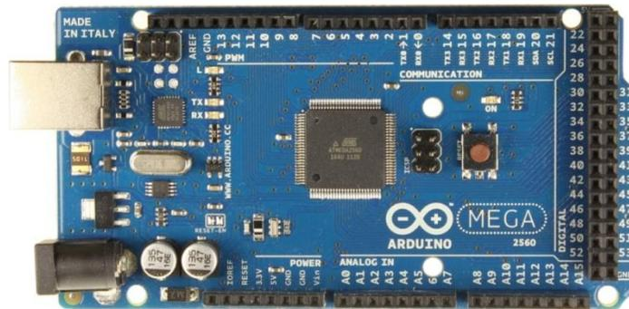
Figura 2.4. Placa de desarrollo: Arduino Mega 2560, basado en ATmega1280.
