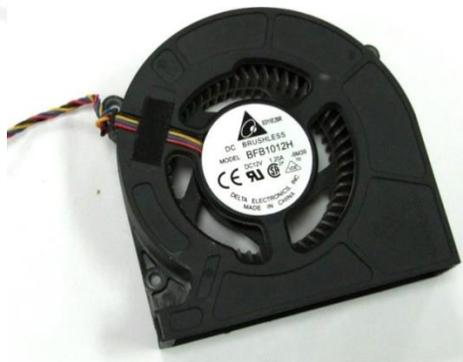
Figura 3.17. Motor extractor de aire Delta Electronics BFB1012H (Anexo 5)
