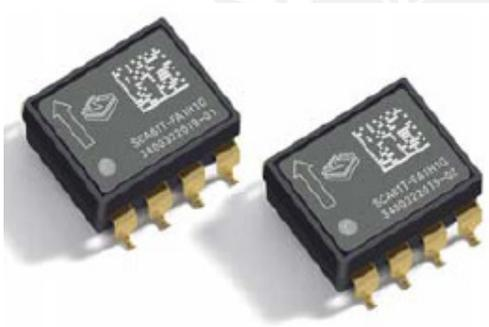
Este modelo especialmente tiene salidas de tipo analógico y digital. La salida digital ahorra la necesidad de contar con un ADC adicional, así los datos binarios representados con una resolución de 11 bits irían directamente al microcontrolador para que sean transformados a ángulo
