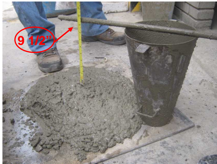
Foto 3.4: Medición del Slump.
