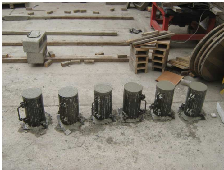
Foto 3.5: Probetas para Ensayo a Compresión.
