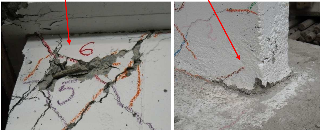
Figura 4.10: Fisuras en la Fase 10 Muro M-2
