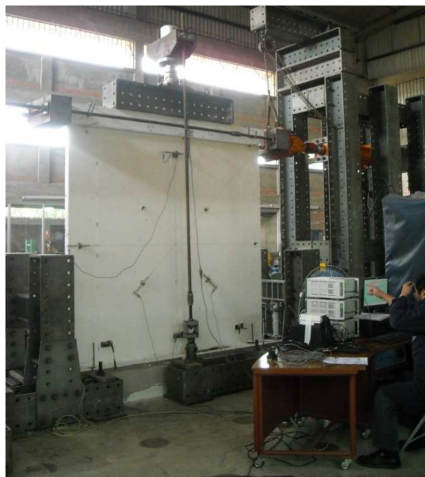
Foto 4.4: Muro listo para ser ensayado
