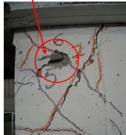
Foto 4.6: Tritución de la esquina superior izquierda
