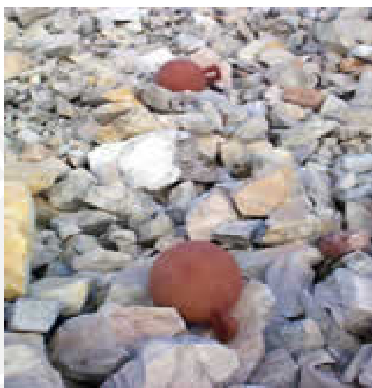
Figura 4.11, Bolas de Escalamiento usadas en una pila de material.
