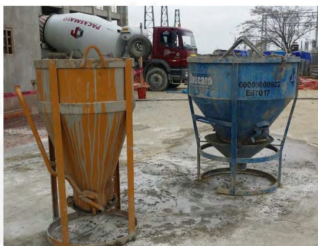
Figura 9.3.- A la izquierda, balde utilizado en mecanismo con winche y castillo. A la derecha, balde utilizado con grúa (3)
