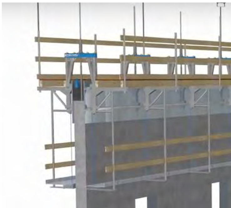
Figura 8.2.- Sección transversal de un encofrado deslizante (7).
