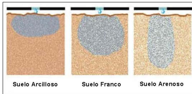
Figura 5: Distribución del agua por Riego por Goteo
