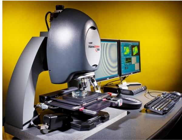
**Figura 2.** Perfilómetro *NewView™ 7300*, producido por Zygo. De Zygo Corporation – Home Page. 2014. Recuperado de <http://www.zygo.com/?/met/profilers/newview7000/>
