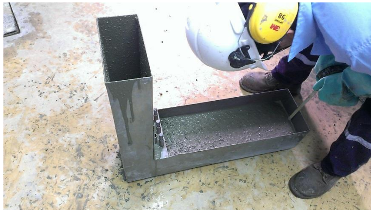
Ensayo de L-box M1
