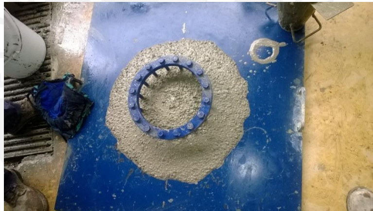
Ensayo J -ring M1
