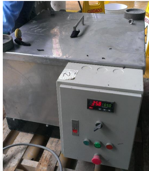
Ilustración 2.8 Equipo de curado a vapor CHARI
