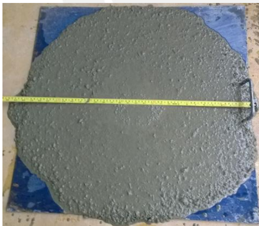
Ilustración 4.18 Slump flow tiempo 0 min
