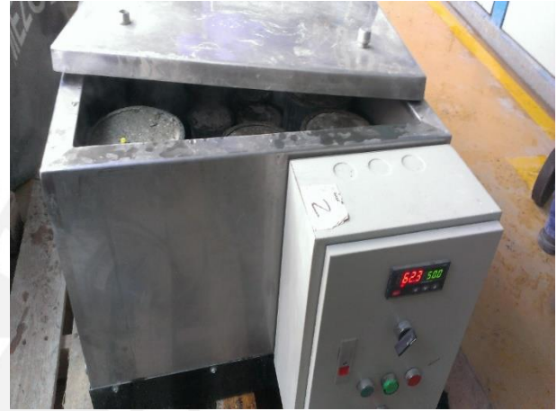
Ilustración 5.12 Curado a vapor EQUIPO CHARI M 6
