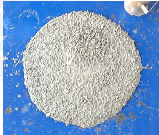
Ilustración 5.6 Slump flow M-3 TIEMPO 60 min
