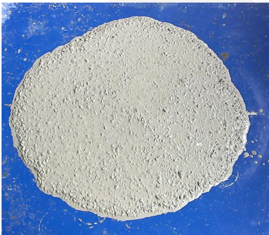
Ilustración 5.3 Slump flow M-2 TIEMPO 0 min
