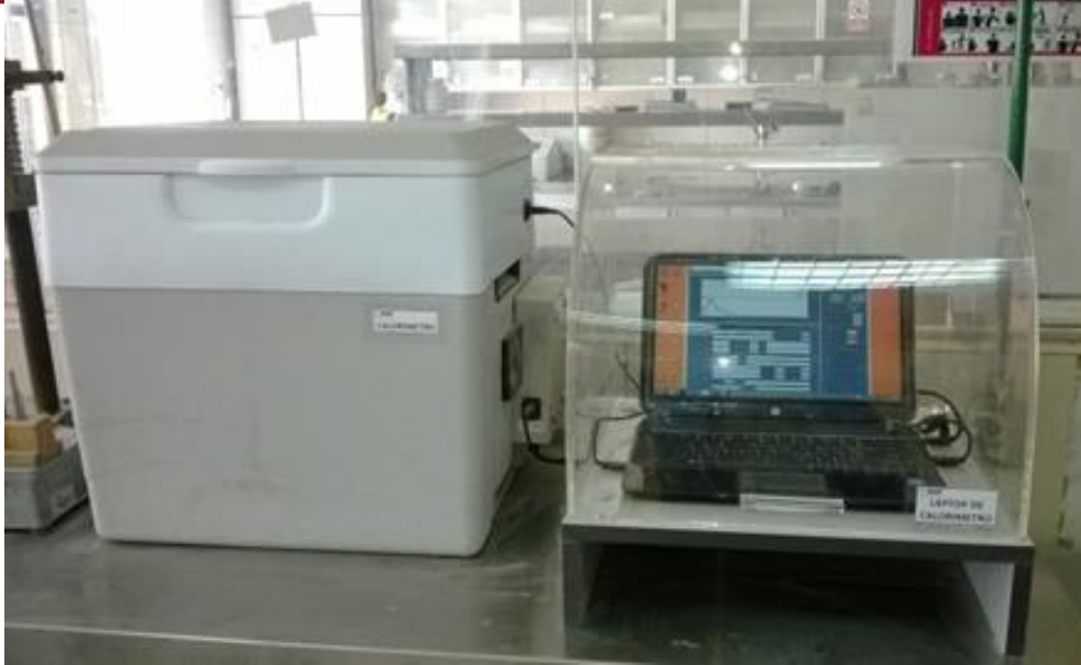
Ilustración 2.7 Equipo de calorimetría I-CAL 400
