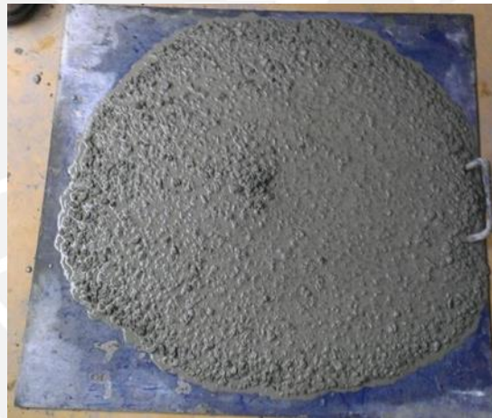
Ilustración 4.1 Ensayo Slump flow MP1
