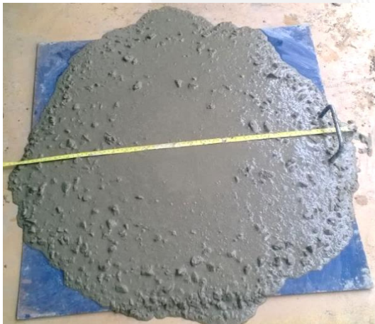
Ilustración 4.14 Slump flow tiempo 0 min
