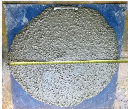
Ilustración 4.19 Slump flow tiempo 60 min
