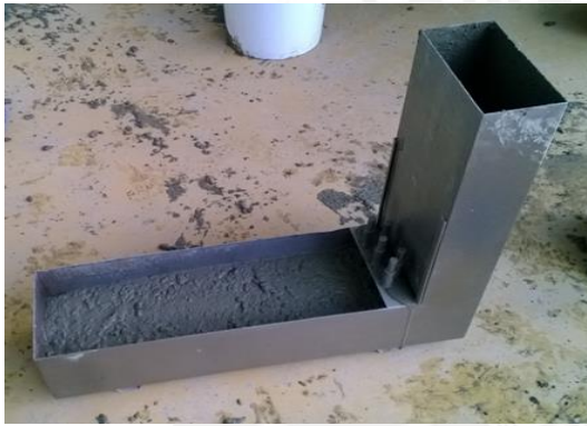
Ilustración 4.10 Ensayo L-box Mezcla D1
