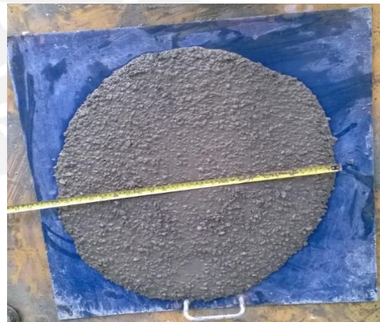
Ilustración 4.17 Slump flow tiempo 60 min
