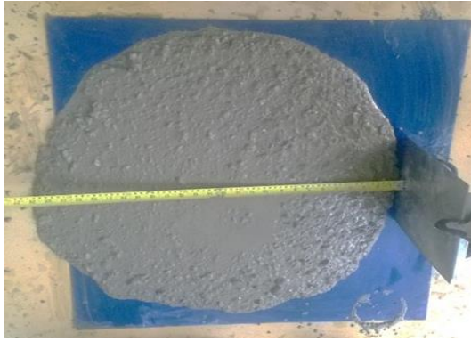
Ilustración 4.8 Ensayo Slump flow Mezcla D1
