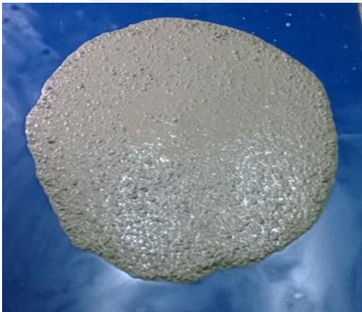
Ilustración 5.1 Slump flow M-1 TIEMPO 0 min
