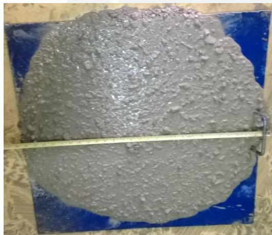
Ilustración 4.12 Slump flow tiempo 0 min
