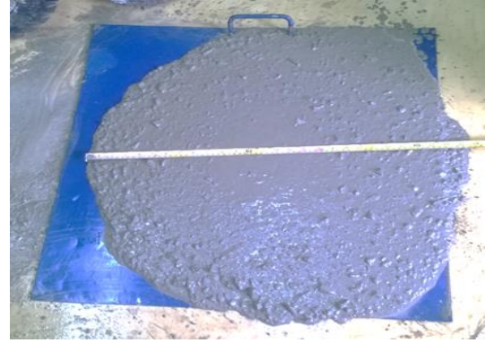
Ilustración 4.9 Ensayo Slump flow Mezcla D2
