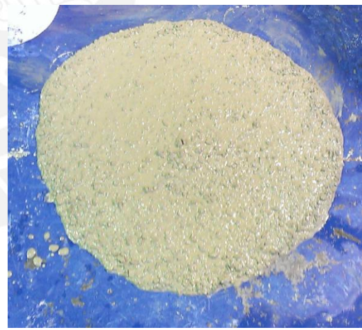
Ilustración 5.10 Slump flow M-5 TIEMPO 60 min
