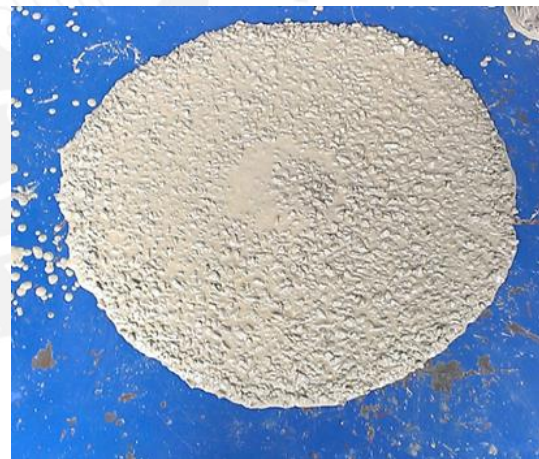
Ilustración 5.4 Slump flow M-2 TIEMPO 60 min
