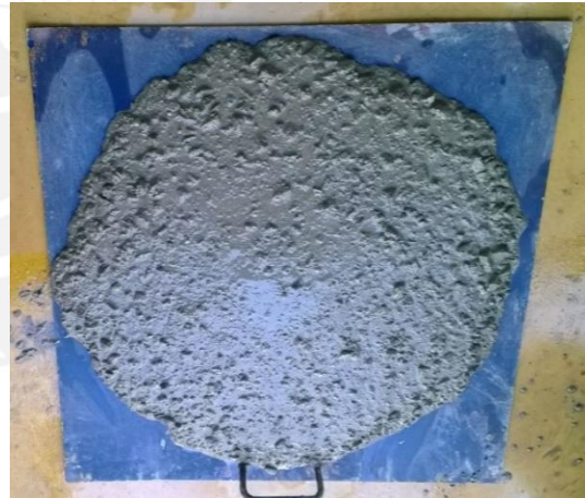
Ilustración 4.15 Slump flow tiempo 60 min
