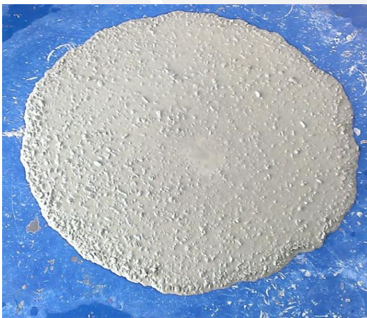
Ilustración 5.5 Slump flow M-3 TIEMPO 0 min
