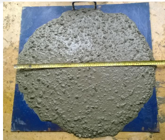
Ilustración 4.6 Mezcla humedad de la arena 8%
