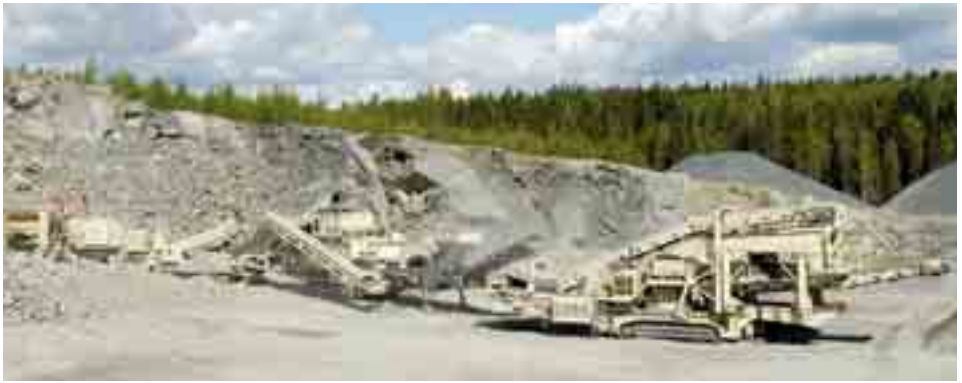
3. Planta de trituración de tres etapas montada sobre orugas, con trituradoras de cono GP secundaria y terciaria.
