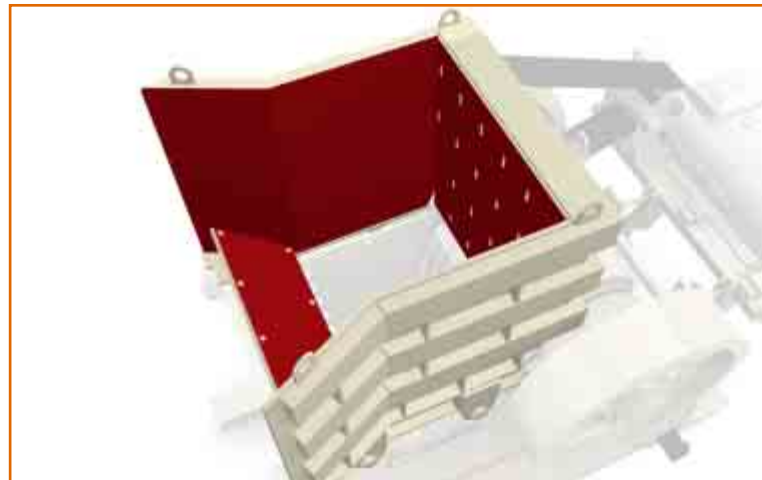
El conducto de alimentación protege eficazmente a la trituradora y puede desmontarse para tareas e mantenimiento.
