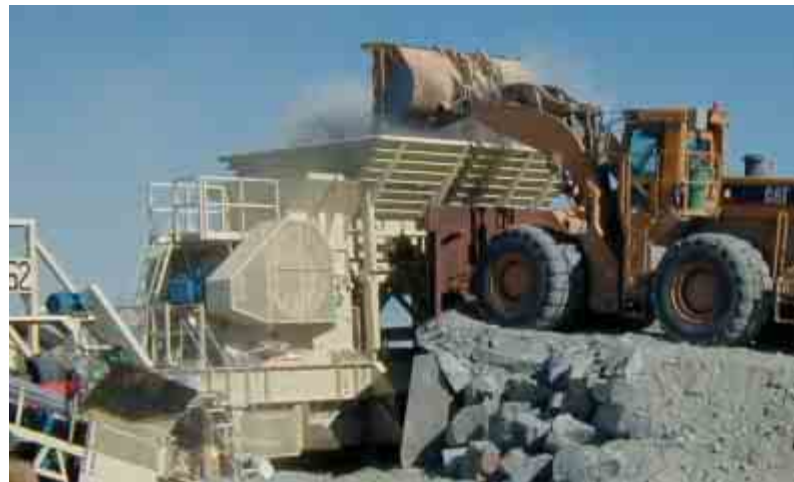
Trituración móvil con la NW125.
