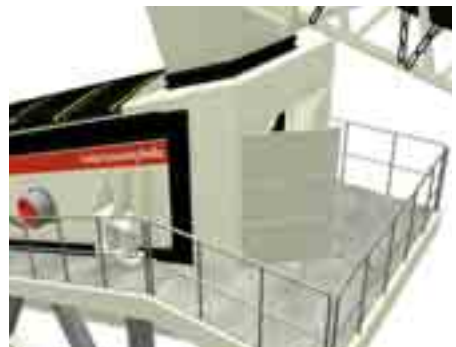
Hay varias maneras de instalar un sistema de control de polvo. Dependiendo de las condiciones, se pueden adaptar fácilmente los perfiles a todos los tipos de criba. Arriba se muestra la llamada "solución francesa".
