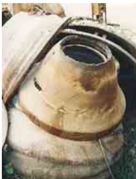
Ejemplo del uso excesivo del forro.
