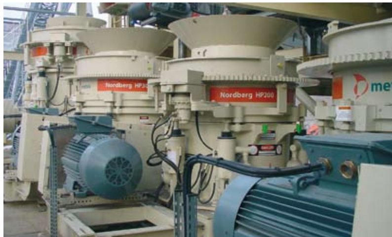
Instalación fija : un molino de cono Nordberg HP500, un HP300, dos HP200.
