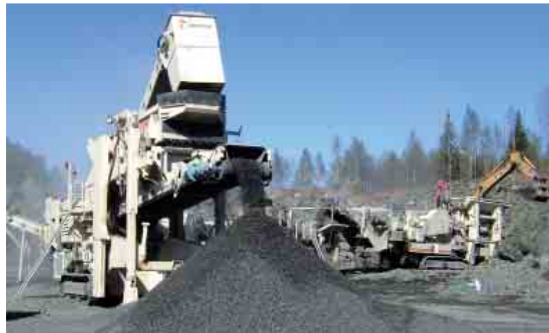
Proceso de trituración y cribado en tres etapas con los modelos Lokotrack LT110, LT300GP y LT300GPB.
