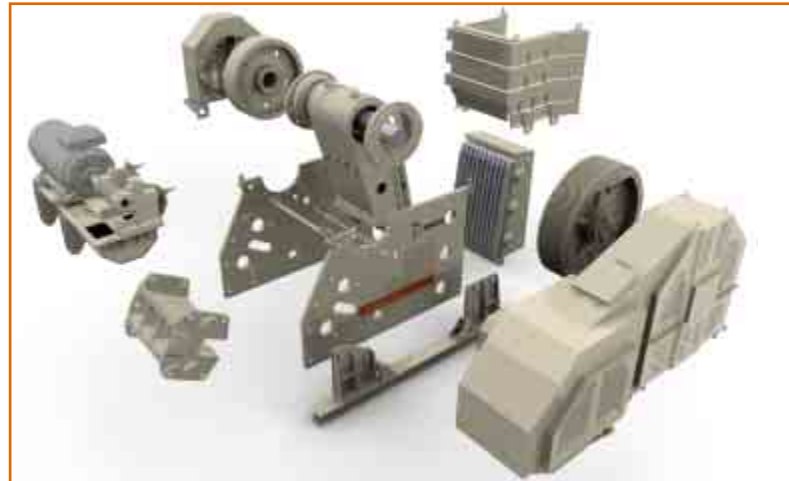
Las trituradoras de mandíbulas de la Serie C, con su diseño con pasadores y pernos, son fáciles de transportar y mover en minas subterráneas estrechas.
