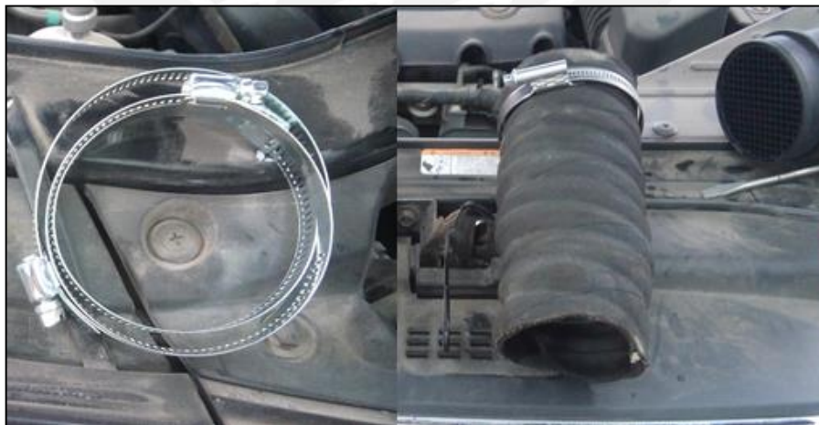
Figura 3.16 - Materiales para la instalación: bridas (lado izquierdo) y manguera de caucho (lado derecho).
