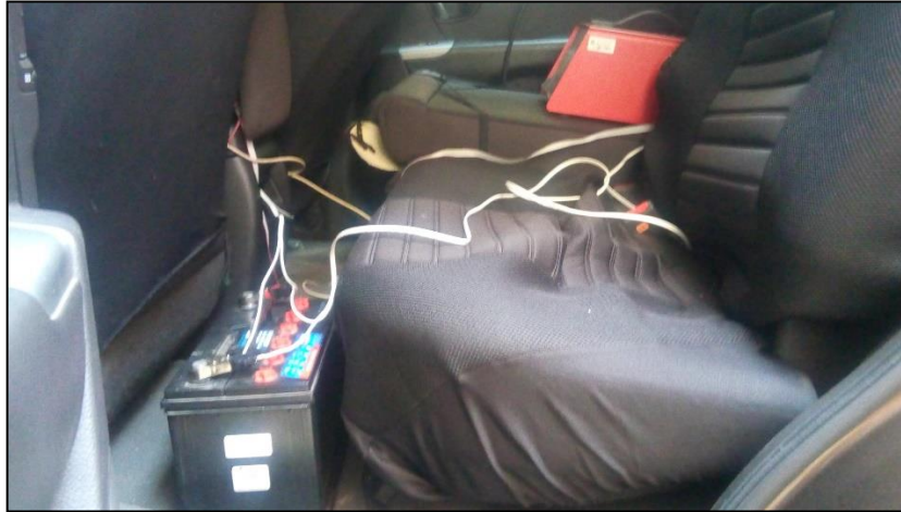
Figura 3.19 - Batería externa para la alimentación del analizador.
