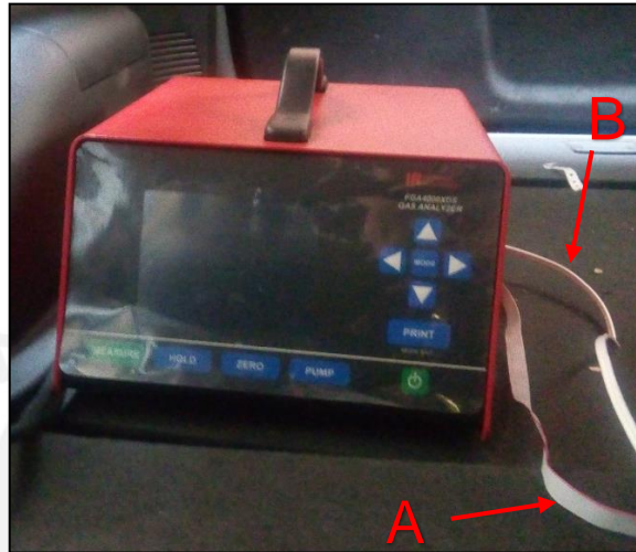
Figura 3.17 - Instalación del analizador de gases dentro del vehículo. A: cable de datos y B: cable de alimentación.
