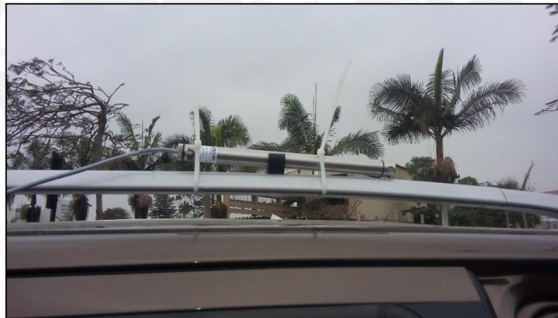
Figura 3.21-Instalación del sensor Omega en la parte superior y exterior del vehículo.
