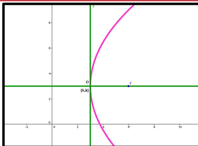
**Figura 20:** Parábola de vértice en  $(h, k)$  y cuyo eje es paralelo al eje Y
