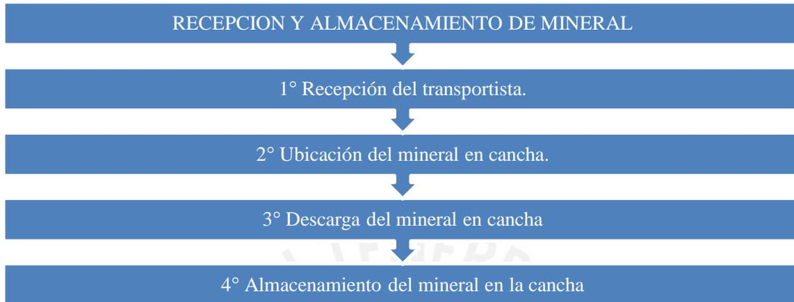
**Figura 40: Proceso de recepción y almacenamiento de mineral**
