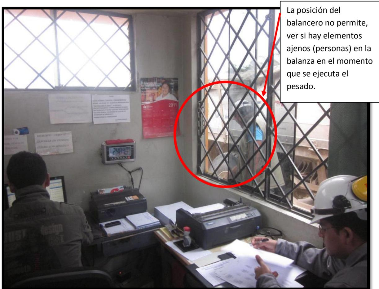
**Figura 11: Vista de elementos ajenos al pesaje**
