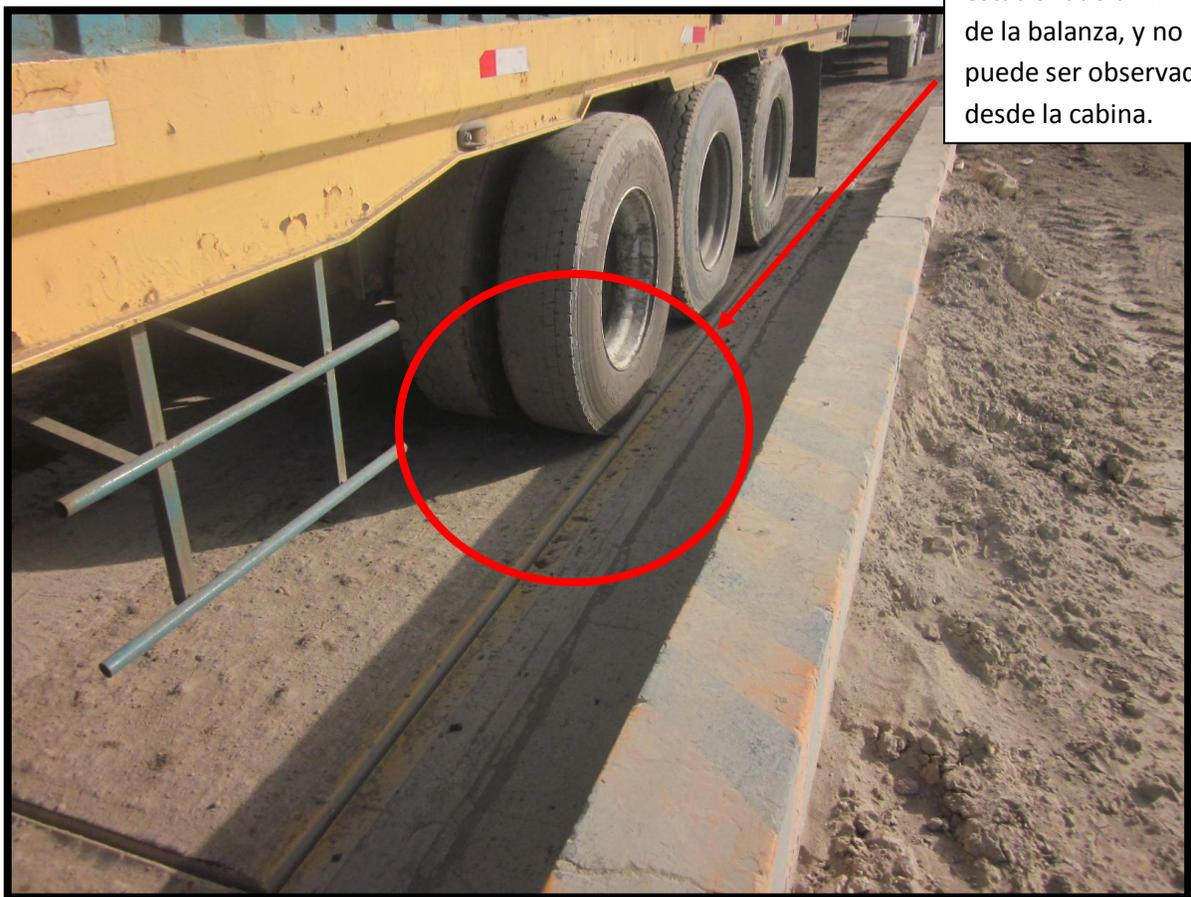
**Figura 12: Llantas al borde de la balanza**
