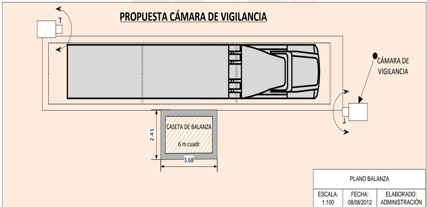
**Figura 52: Cámaras de vigilancia supervisando el pesaje**
