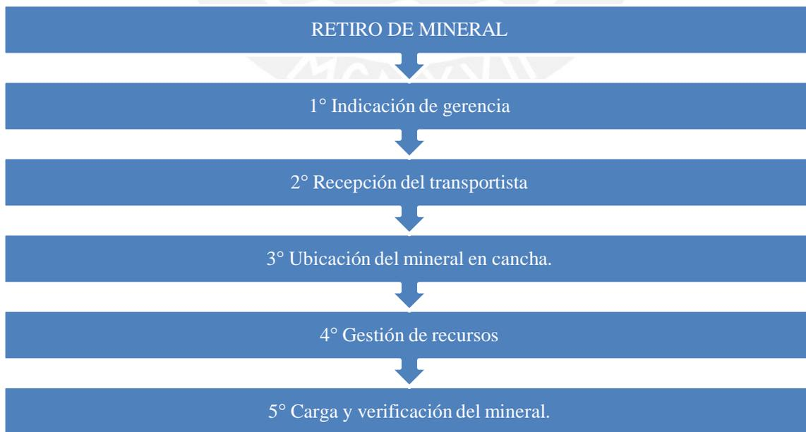
**Figura 44: Proceso de retiro de mineral**
