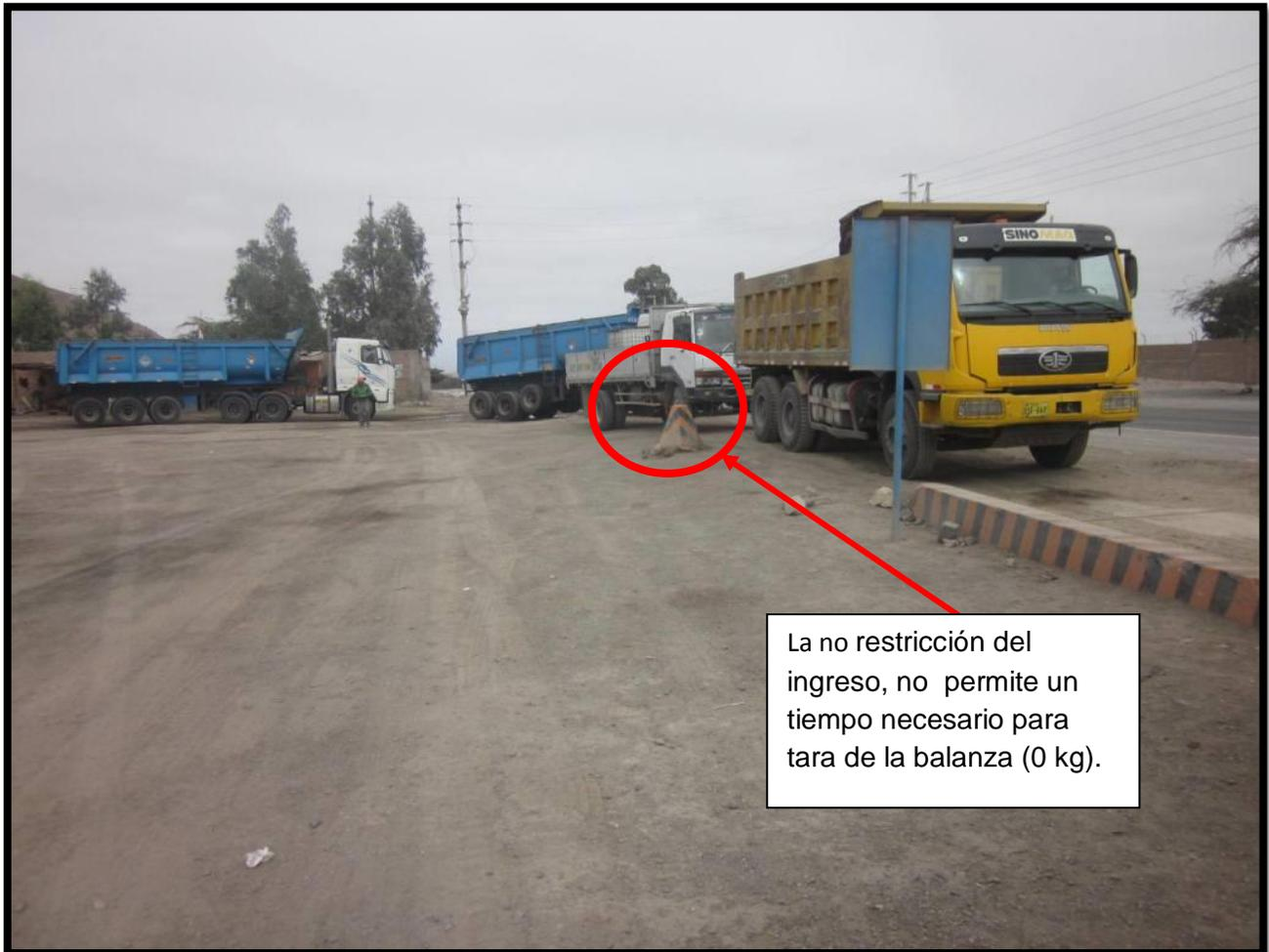
**Figura 13: Ingreso de camiones a la balanza y falta de rompe muelle.**
