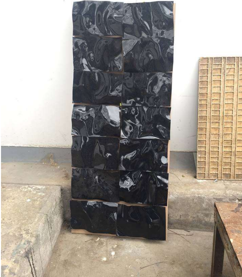
Ensamblaje de las piezas de acrílico a los paneles de MDF
