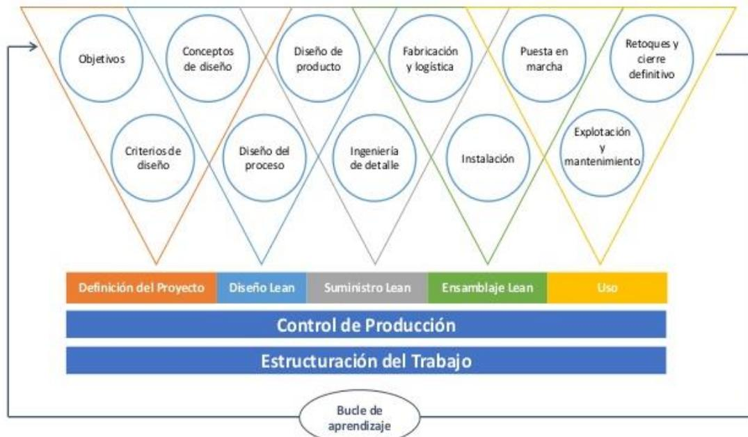
Figura 2.3. Flujo de producción del LPDS (Ballard, 2000)
