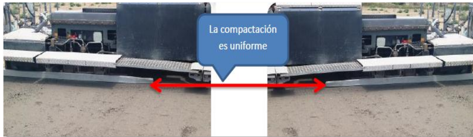
Figura 31. Precompactación que otorga la Esparcidora.
