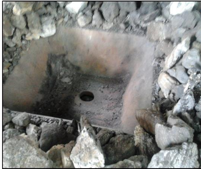
Figura 1.4. Corazón de la fragua
