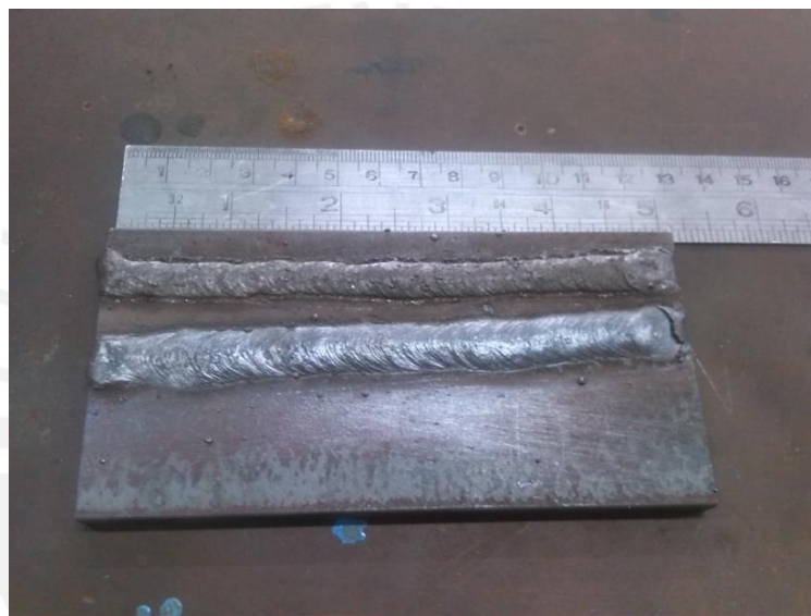
Figura 2.4. Cordones de soldadura con electrodo E6011 (superior) y E6013 (inferior).
