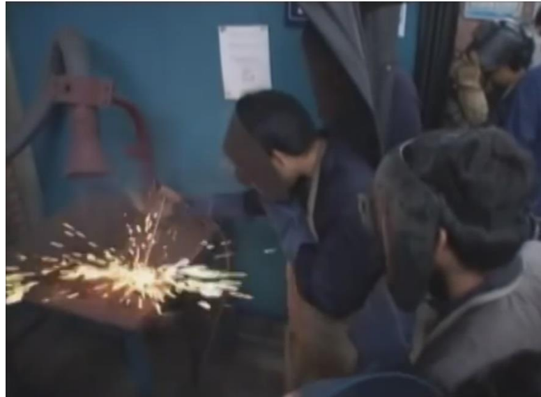
Figura 1.5. Alumnos de Ingeniería practicando el proceso SMAW en el Laboratorio. [Ref. 1.18].
