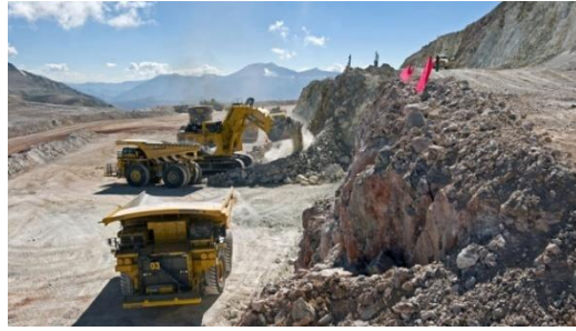
Figura 3.- Mina tajo abierto, remoción de capas de excedentes y mineral
