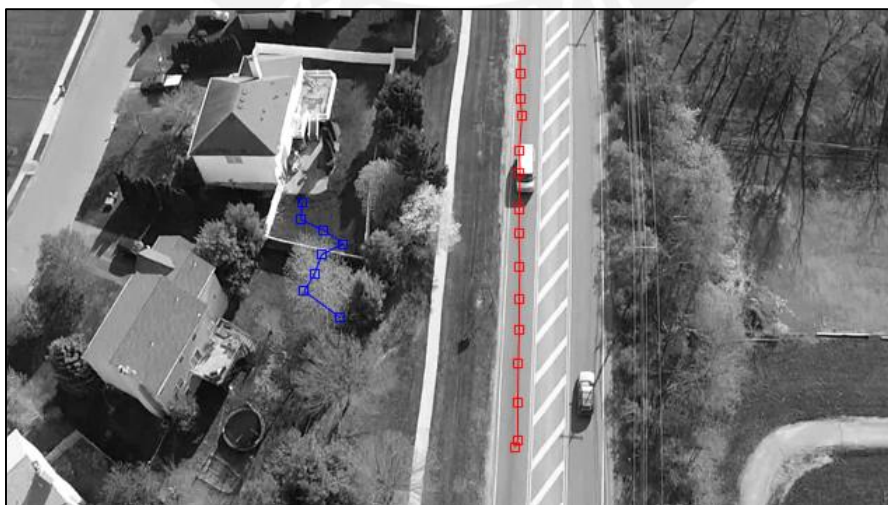
Figura 4.38: Trayectorias seguida por los blob 73 y 74, que representa a un vehículo y un objeto no correcto, respectivamente.
