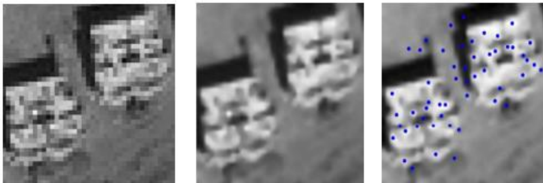
Figura 1.5: Sección de la imagen. (a) imagen original. (b) imagen original filtrada. (c) puntos claves obtenidos mediante SIFT [4].
