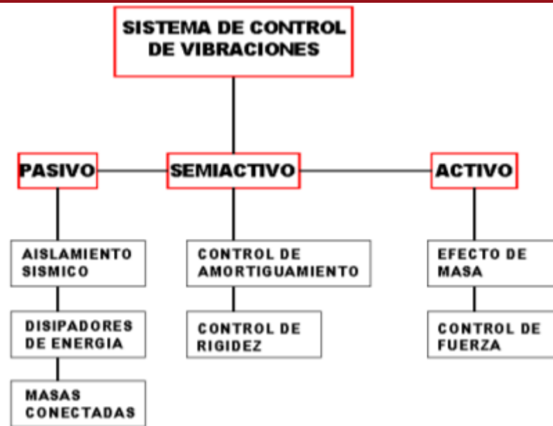
Figura 2.3: Clasificación del control de vibraciones.
