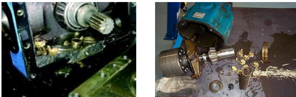
Figura 1.11. Fallas interna de bomba de pistones axiales [7]
