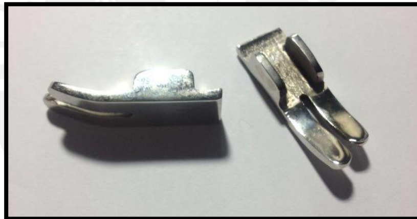
Figura 3.35. Pulido y niquelado, Pieza 2
