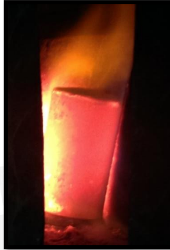
Figura 4.26. Elevar la temperatura a 700°C del molde de yeso.
