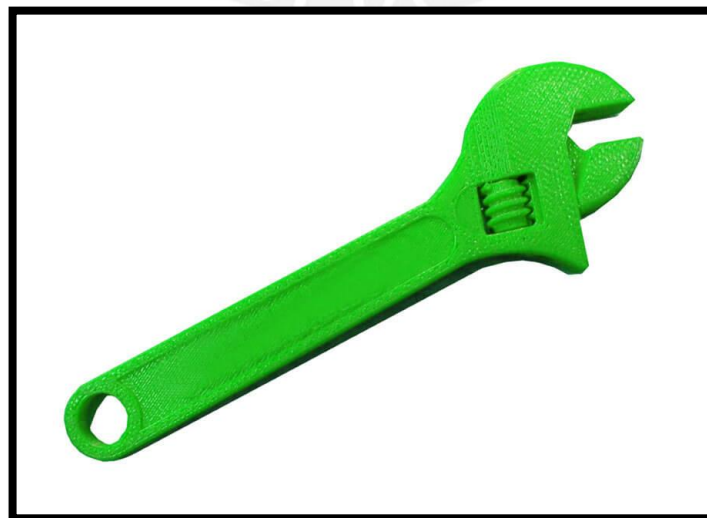
Figura 2.2 Pieza obtenida por impresión en ABS. [19]
