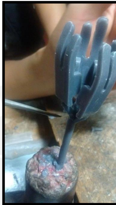
Figura 4.16. Proceso de armada de árbol de cera
