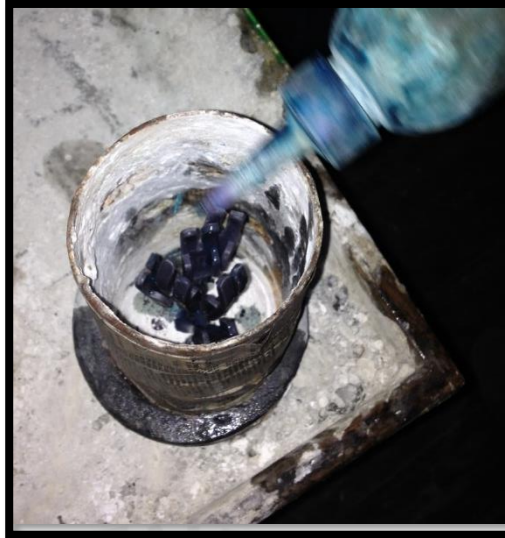
Figura 4.22. Adición de alcohol al árbol de cera.
