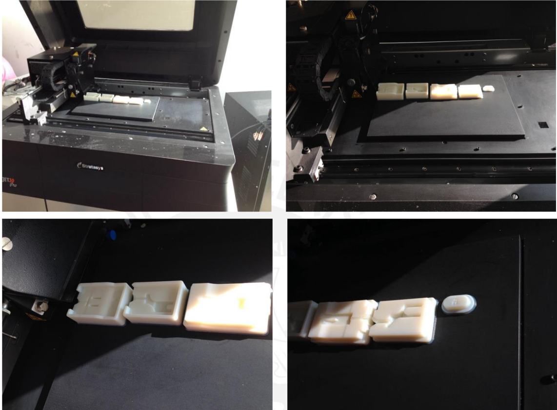
Figura 4.13 Proceso de impresión de los moldes para la Pieza1 y 2.
