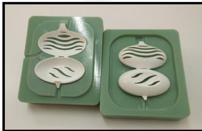
Figura 2.6 Moldes de material termoplástico ABS. [22]
