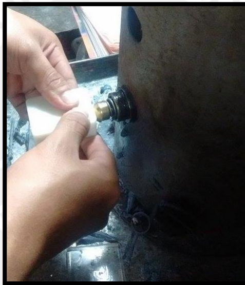
Figura 2.4 Inyectado de cera en molde de material termoplástico.
