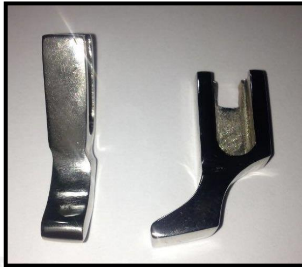
Figura 3.34. Pulido y niquelado, Pieza 1
