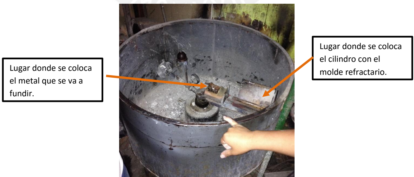
Figura 4.27. Máquina de centrifugado
