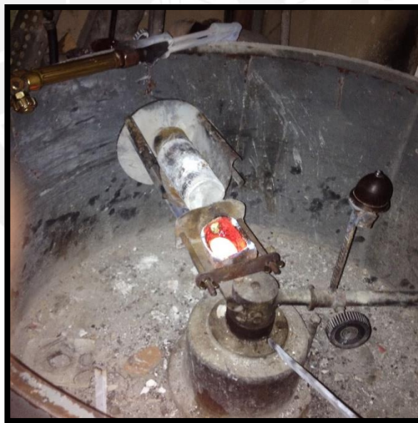
Figura 4.29 Inicio del vertido de metal fundido
