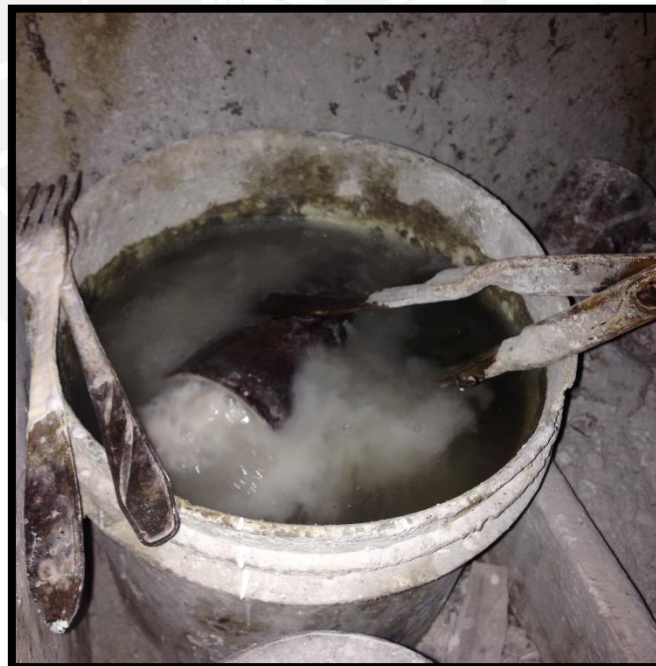
Figura 4.31. Sumergir el molde de yeso en un balde con agua.
