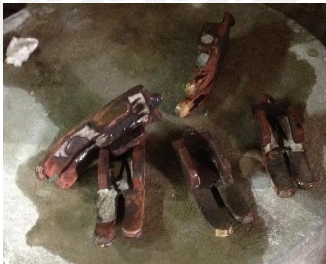
Figura 4.33. Pieza fundida final, sin acabado.
