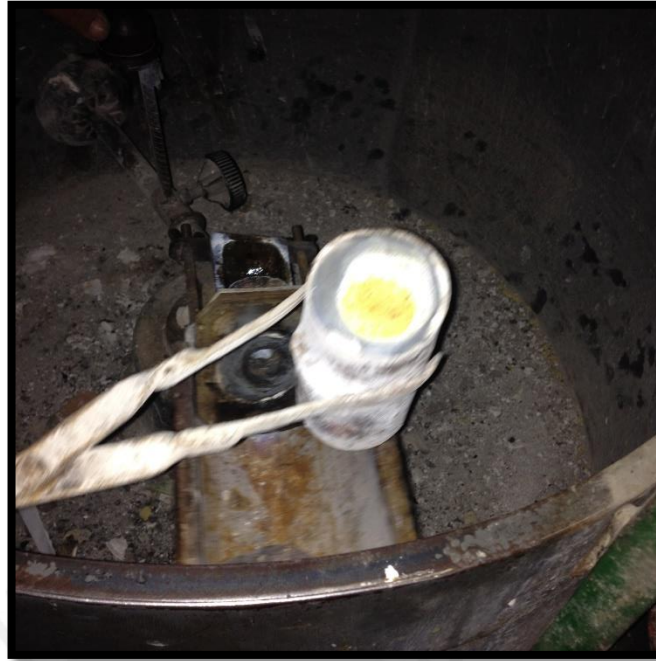
Figura 4.30. Extracción del molde yeso de la maquina centrifuga.
