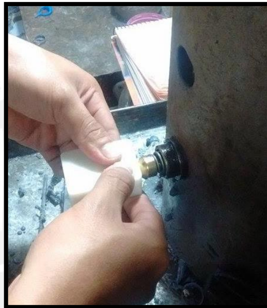
Figura 4.14. Inyectado de cera en el molde impreso con tecnología polyjet.
