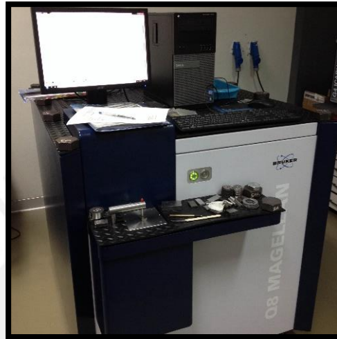
Figura 3.3. Máquina de análisis químico: BRUKER Q8 MAGELLAN.
