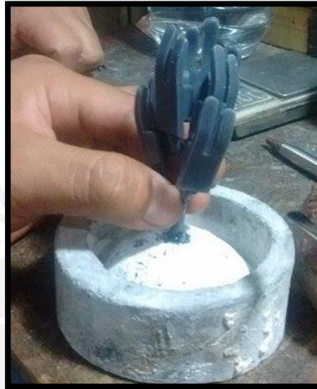
Figura 4.17. Soldar el árbol de cera a la tapa cilíndrica
