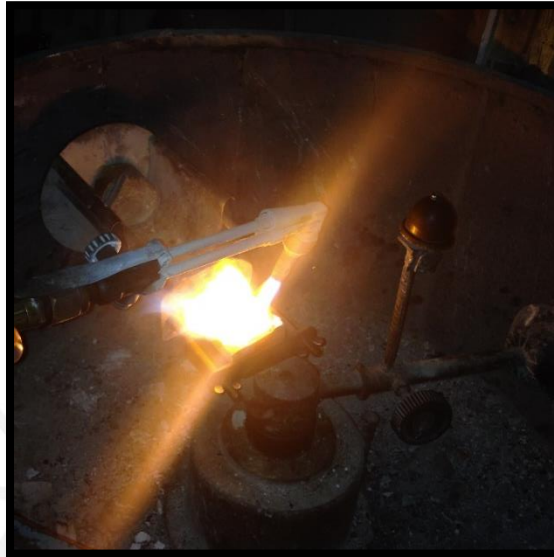
Figura 4.28 Fundición del bronce
