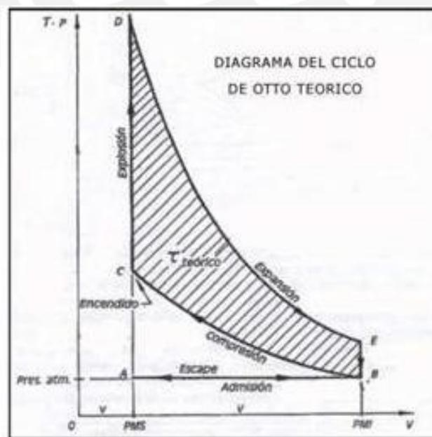
Figura 1.4 - Diagrama de ciclo del motor [14]
