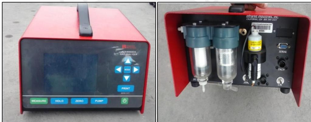
Figura 3.12 - Analizador de gases portátil marca Infrared Industries.
